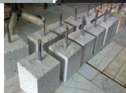
شکل ۱- نحوه قالب‌گیری و دستگاه تست کشش میلگرد
