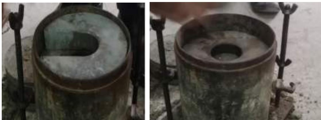
شکل ۴۱-۱۳: قرار دادن وزن حلقوی سطح نمونه
