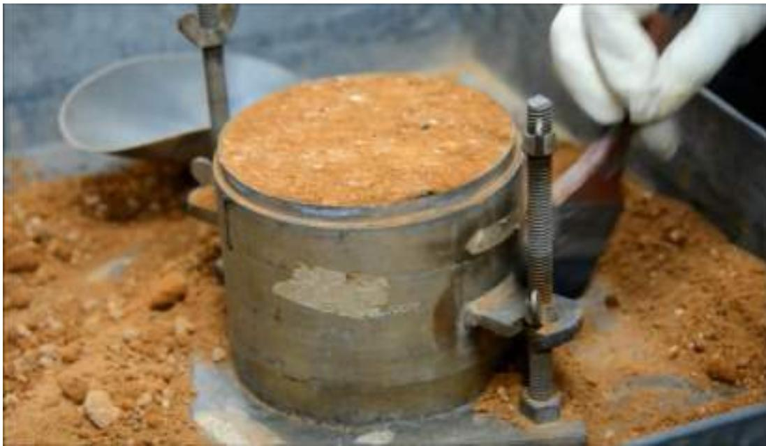
شکل ۴۰-۱۳: تمیز کردن اطراف قالب تراکم توسط برس
