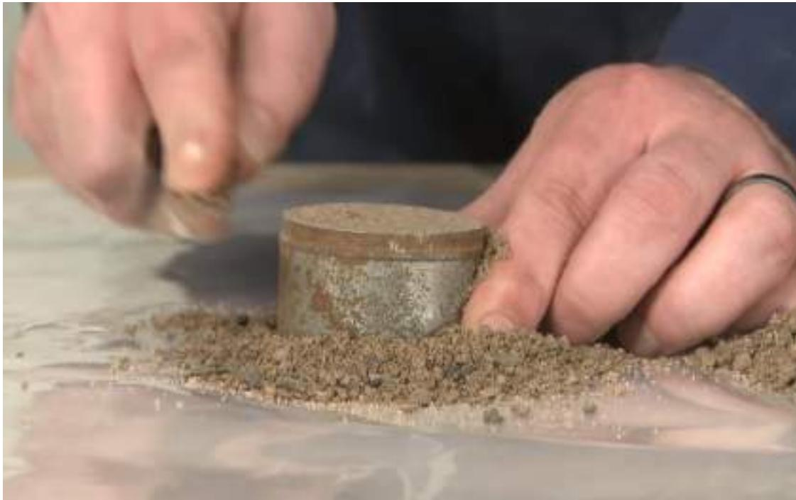
شکل ۳۷-۷: شکل حاصله پس از تراز کردن سطح نمونه
