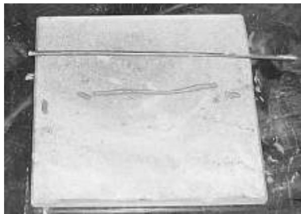
شکل ۲۱-۵: نمونه ساخته شده ترک خورده به قطر  $\frac{1}{8}$  اینچ و میله مبنا به قطر  $\frac{1}{8}$  اینچ
