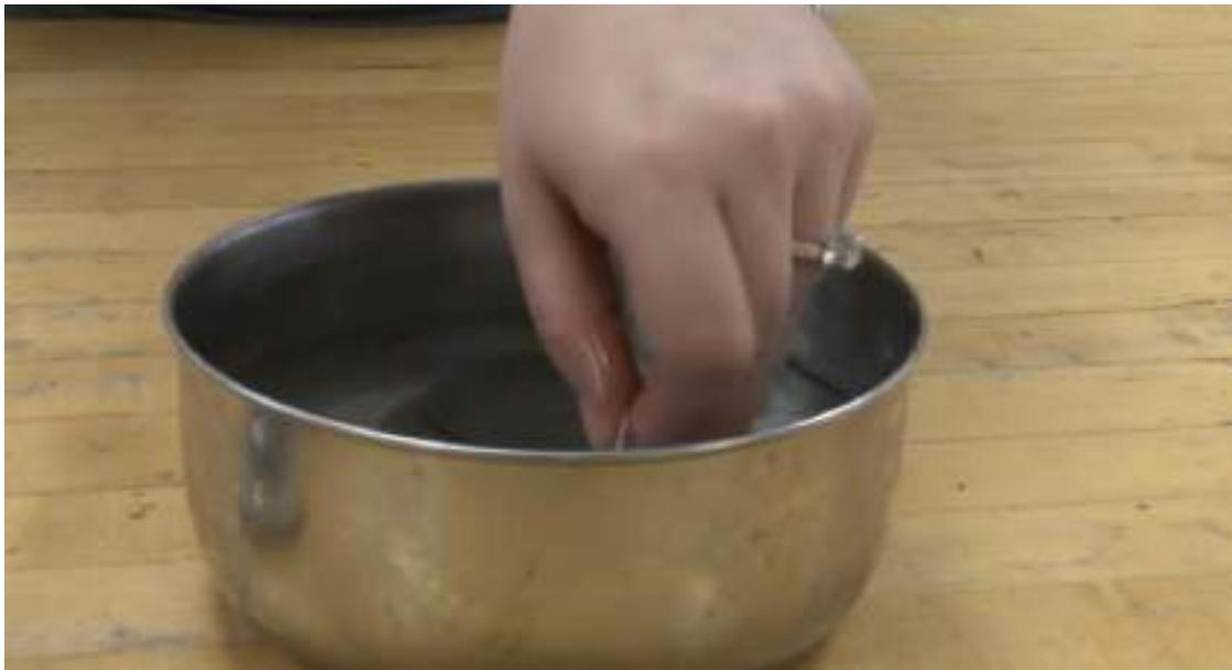
شکل ۴۲-۱۴: اشباع کردن سنگ متخلخل با قرار دادن آن داخل ظرف آب
