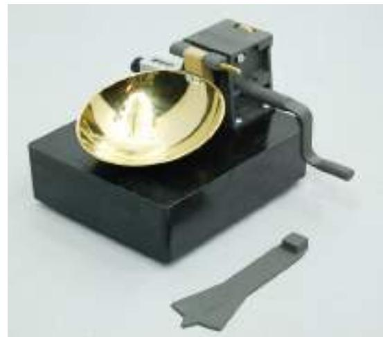
شکل ۵-۴: دستگاه حد روانی کاساگرانده به همراه شیارکش
