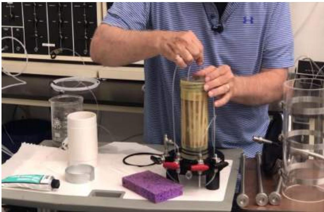
شکل ۱۸-۶۰: نصب لوله‌های زهکشی به قسمت بالایی کلاهک دستگاه
