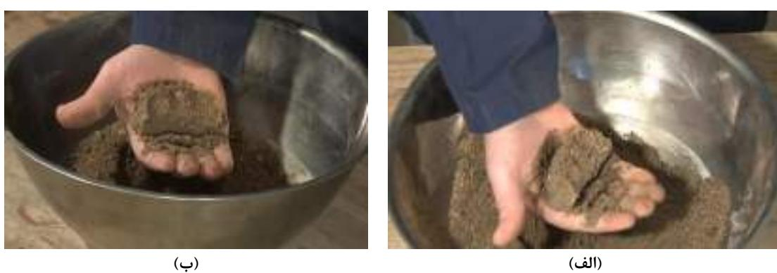
شکل ۷-۲۶: شکل حاصله از رطوبت مناسب نمونه پس از بازکردن دست
