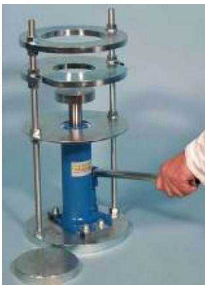
شکل ۹-۱۰: دستگاه خارج کردن نمونه از قالب تراکم
