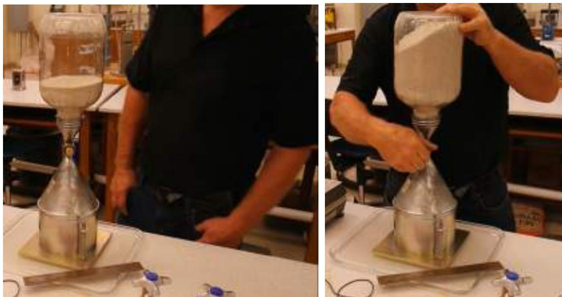
شکل ۱۳-۱۲: باز کردن شیر مخروط ماسه و پر کردن قالب تراکم
