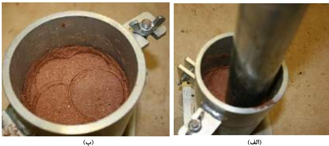
شکل ۱۶-۱۰: مراحل تراکم هر لایه خاک: (الف) ضربه چکش به تمامی قسمت‌های نمونه؛ ب) شکل حاصله پس از اتمام هر لایه
