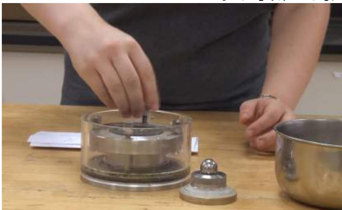
شکل ۱۴-۵۳: بستن پیچ‌های حلقة فلزی
