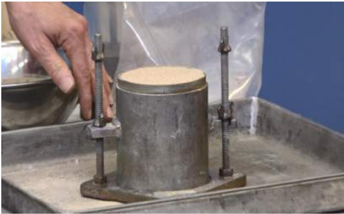
شکل ۱۵-۱۱: ماسه به همراه قالب پس از تمیز کردن اطراف قالب و صفحه کف
