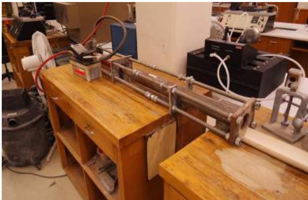
شکل ۲۹-۱۴: دستگاه هیدرولیکی خارج کردن نمونه‌های دستنخورده از نمونه‌گیر
