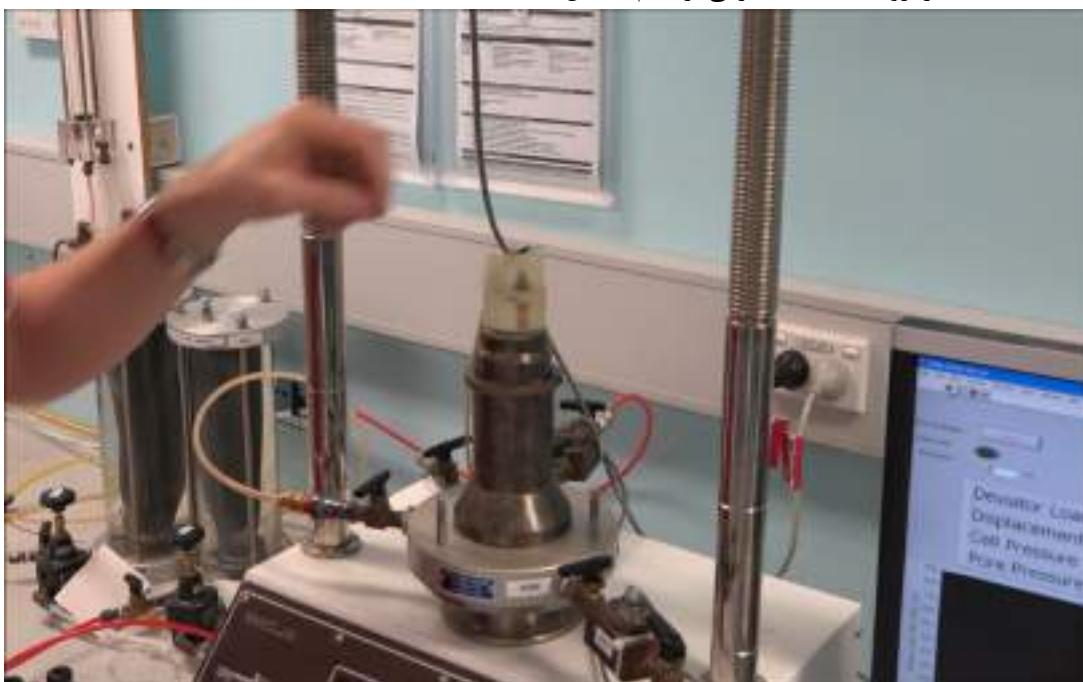
شکل ۱۸-۷۹: قرار دادن غشاء پلاستیکی داخل قالب غشاء
