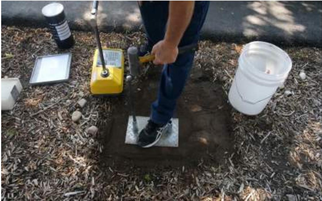
شکل ۳۸-۱۲: ضربه زدن به میله مذکور به منظور داخل شدن به زمین
