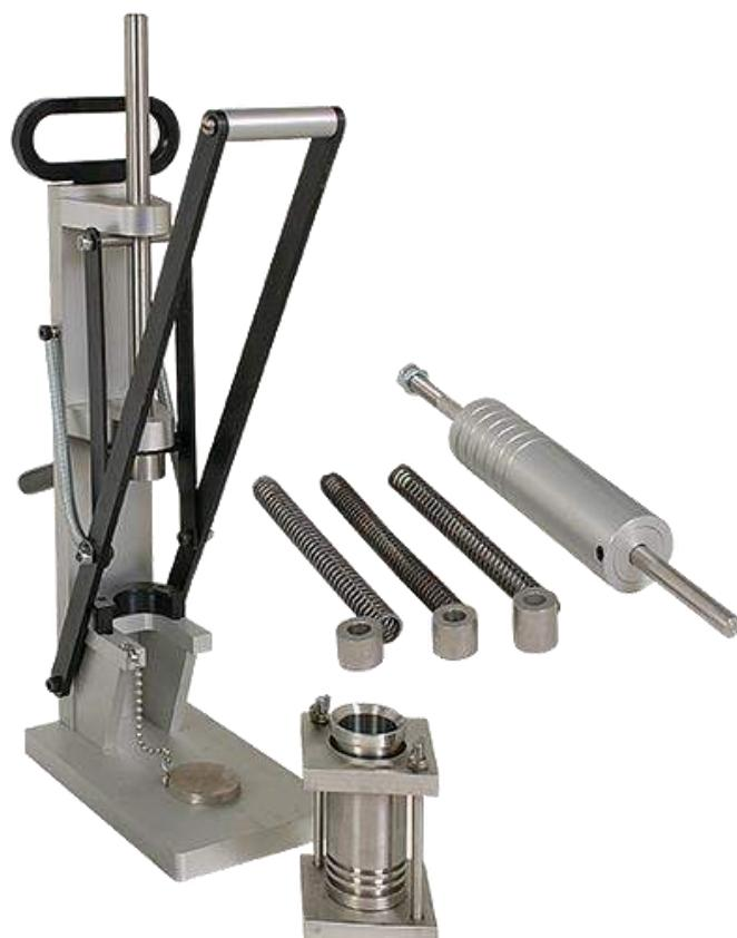
شکل ۹-۱۷: دستگاه تراکم و ملحقات آن
