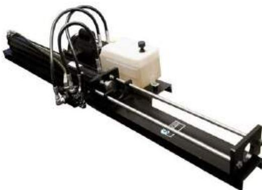
شکل ۲۷-۱۸: دستگاه هيدروليكي خارج کردن نمونه‌های دست-نخورد از نمونه‌گير
