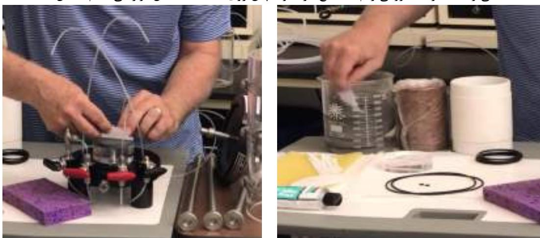
شکل ۴۷-۱۸: قرار دادن کاغذ صافی روی سنگ متخلخل
