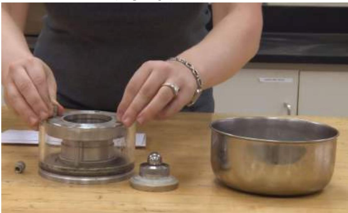
شکل ۱۴-۵۱: قرار دادن حلقه بالایی داخل سلول دستگاه تحکیم روی سنگ متخلخل
