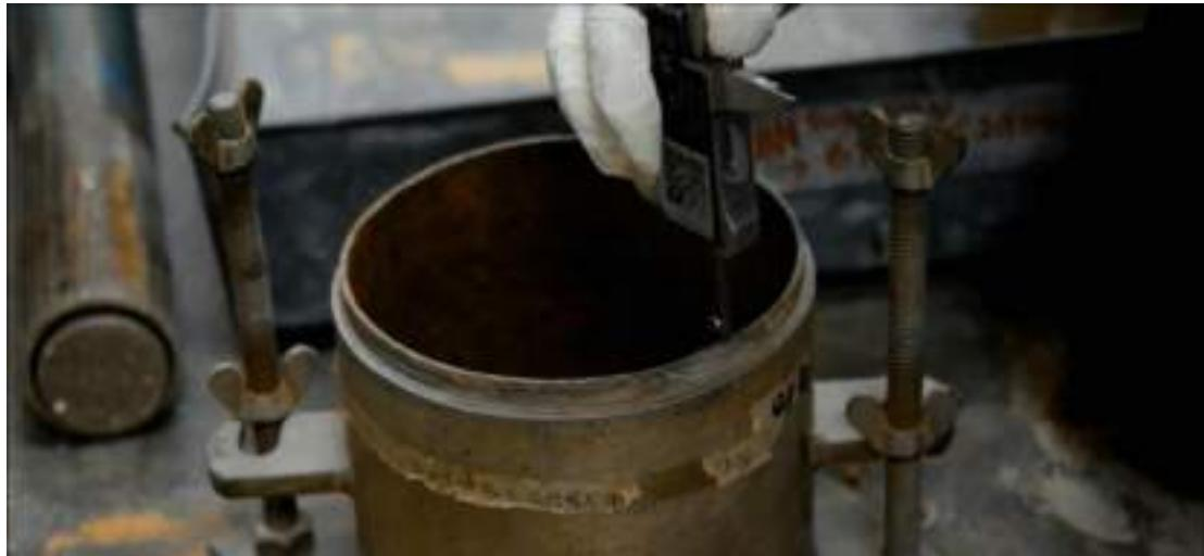
شکل ۳۰-۱۳: اندازه‌گیری ارتفاع قالب تراکم توسط کولیس
