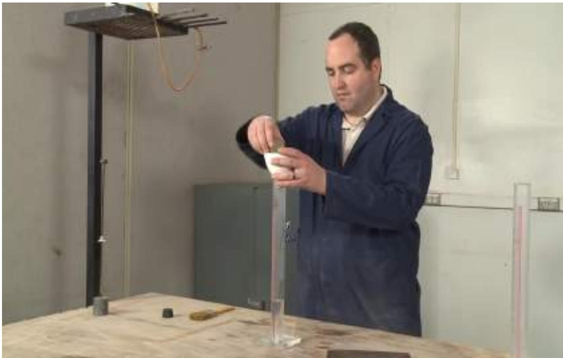
شکل ۴۰-۷: قراردادن قیف بر روی استوانه و ریختن خاک به داخل استوانه
