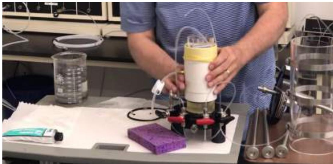
شکل ۱۸-۵۶: قرار دادن غشاء روی نمونه
