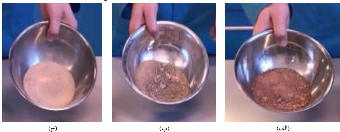
شکل ۱-۱۷: تعیین شرایط رطوبت خاک: (الف)، (ب)، (ج) خشک
