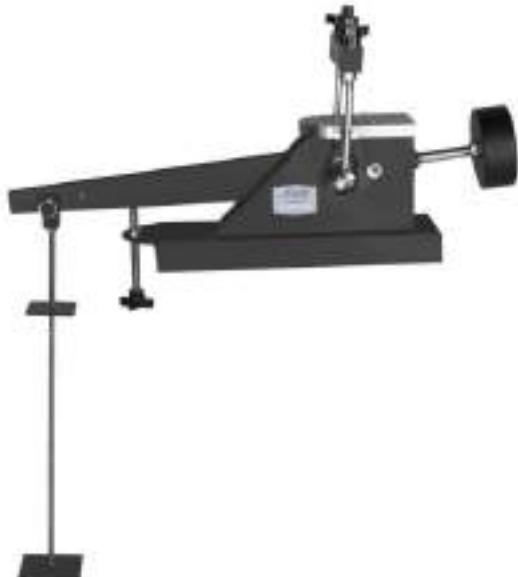
شکل ۱-۱۵: دستگاه آزمایش تحکیم یک بعدی (بار مرده)
