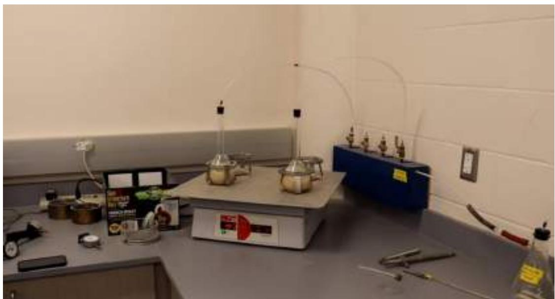
شکل ۲۰-۳: نمونه پیشرفته‌تر از عمل خروج هوای محبوس از داخل نمونه آب - خاک: در این حالت فلاکس حجمی روی دستگاه لرزاننده مخصوص قرار گرفته و از قسمت فوقانی به دستگاه مکش متصل می‌شود.
