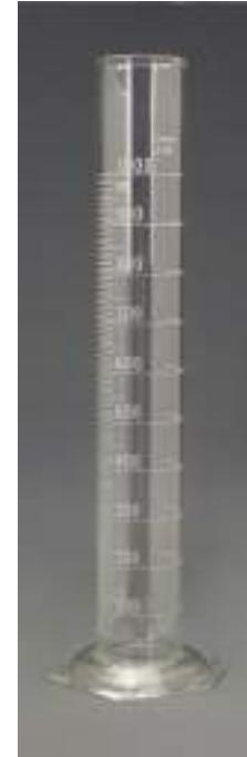
شکل ۴-۱۷: استوانه مدرج به حجم ۱۰۰۰ سی سی
