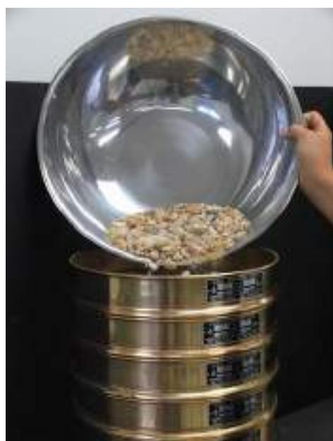
شکل ۸-۴: ریختن نمونه خاک درون الک‌ها
