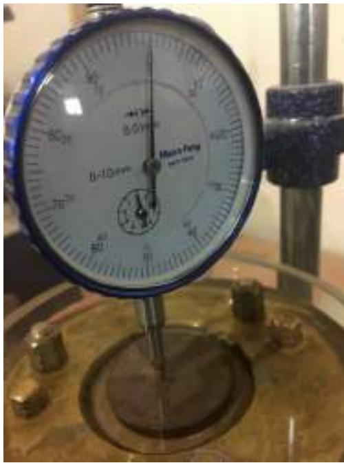
شکل ۱۸-۱۵: ساعت اندیکاتور در انتهای آزمایش فشار تورم
