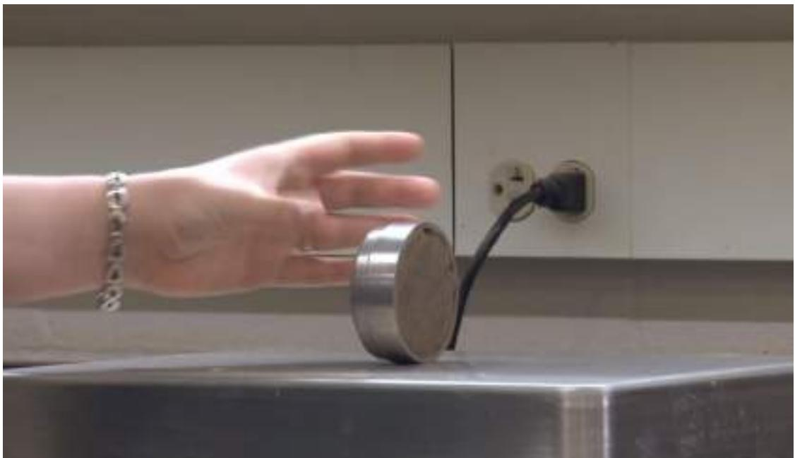
شکل ۱۴-۴۱: اندازه گیری جرم حلقه برنجی و نمونه خاک
