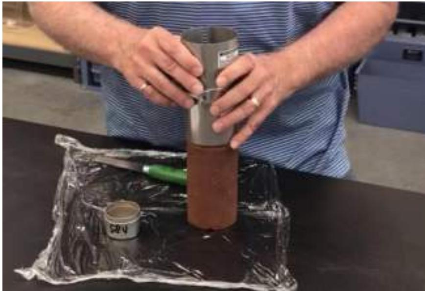
شکل ۳۳-۱۸: قرار دادن استوانه اصلاح‌کننده نمونه در اطراف نمونه
