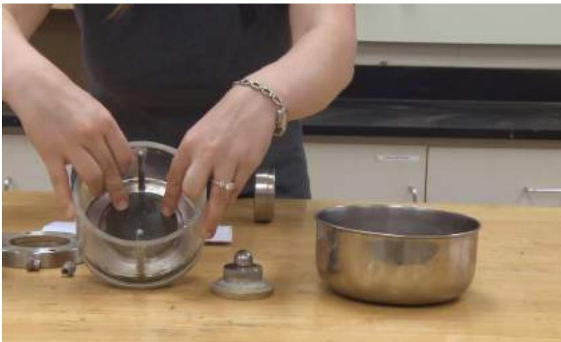
شکل ۴۳-۱۴: قرار دادن سنگ متخلخل داخل سلول دستگاه تحکیم
