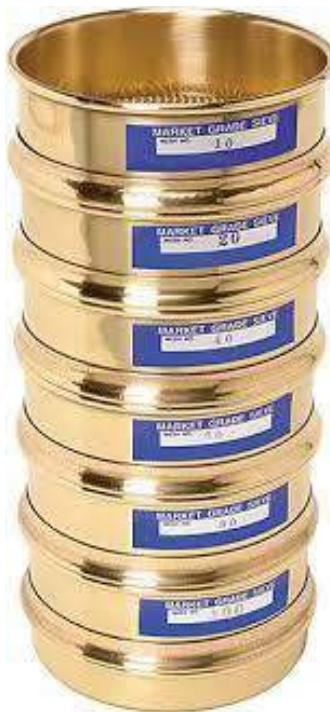
شکل ۷-۴: نمونه‌ای از چیدمان الک‌ها
