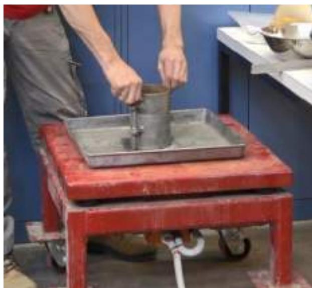
شکل ۱۷-۱۱: قراردادن قالب و سینی زیرین روی صفحه دستگاه ارتعاش مکانیکی
