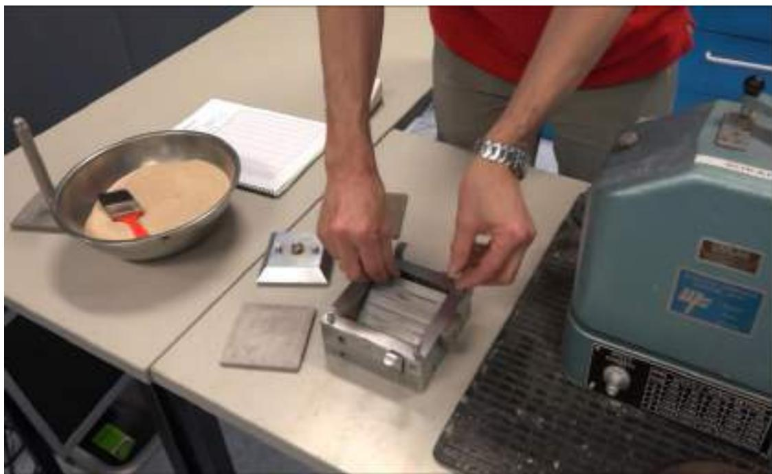
شکل ۳۹-۱۶: صفحه پایه یا نگهدارنده باید به گونه‌ای قرار گیرد که شیارهای آن موازی با جهت برش باشد
