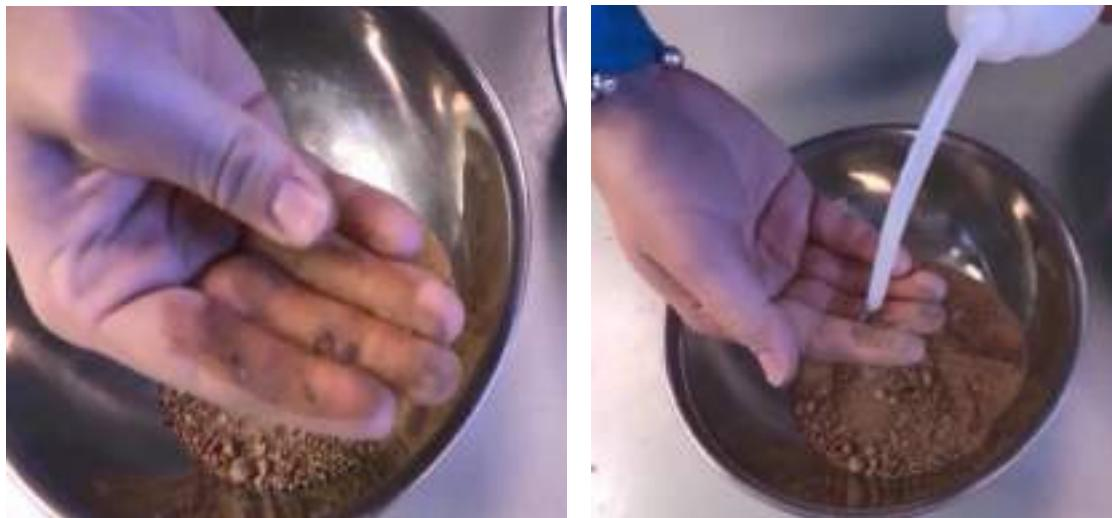
شکل ۱۴-۱: تشخیص بین رس و سیلت بودن بخش ریزدانه با اضافه کردن آب
