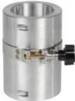
شکل ۱۸-۲۹: استوانه اصلاح کننده نمونه
