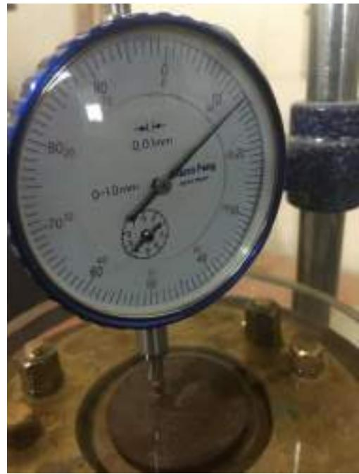
شکل ۱۷-۱۵: ساعت اندیکاتور در انتهای آزمایش تورم و ابتدای آزمایش فشار تورم
