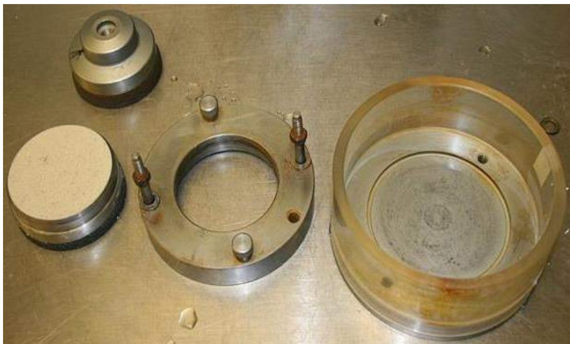
شکل ۳۰-۱۴: حلقه فلزی و ملحقات دستگاه تحکیم
