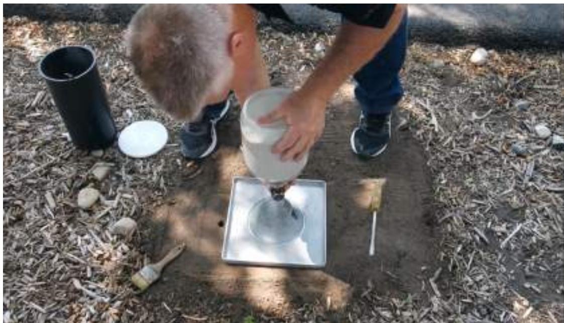
شکل ۲۲-۱۲: قرار دادن مخروط ماسه روی سینی مخصوص آن
