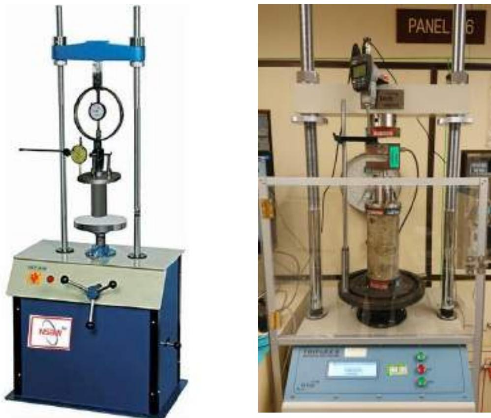
شکل ۱۷-۵: نمونه‌هایی از دستگاه آزمایش مقاومت فشاری محصورنشده (تکمحوری)
