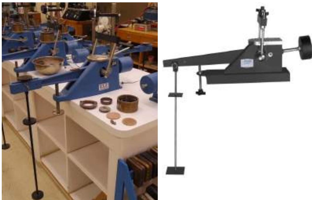
شکل ۲۱-۱۴: دستگاه آزمایش تحکیم یکبعدی (بار مرده)
