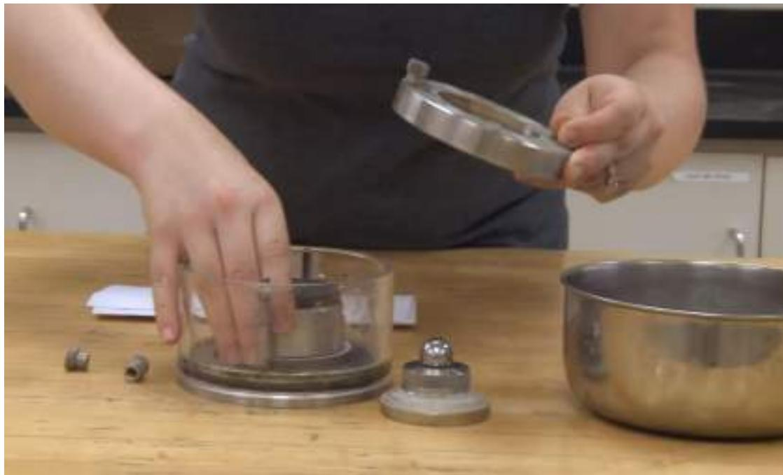
شکل ۱۴-۵۲: قرار دادن تمامی لایه‌ها در مرکز سلول دستگاه
