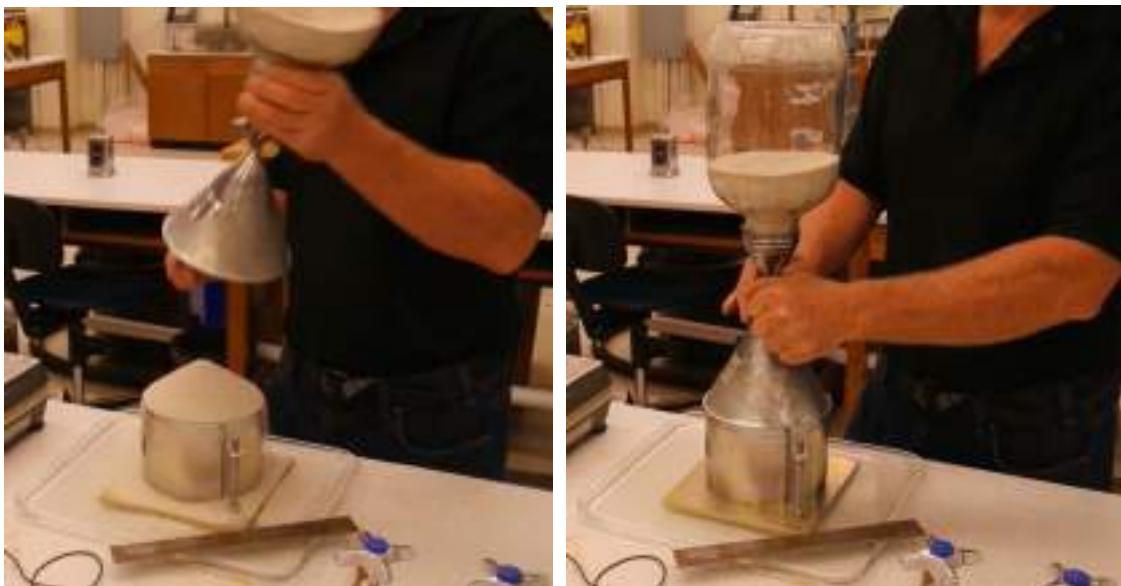
شکل ۱۴-۱۲: باز کردن شیر مخروط ماسه و پر کردن قالب تراکم
