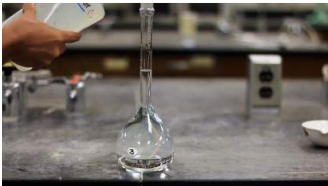
شکل ۱۳-۳: شکل نهایی آب مقطر افزوده شده تا علامت مشخص
