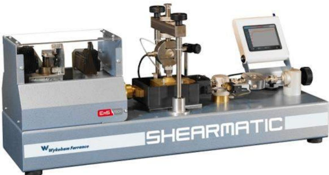
شکل ۱۶-۱۶: دستگاه آزمایش برش مستقیم مکانیکی
