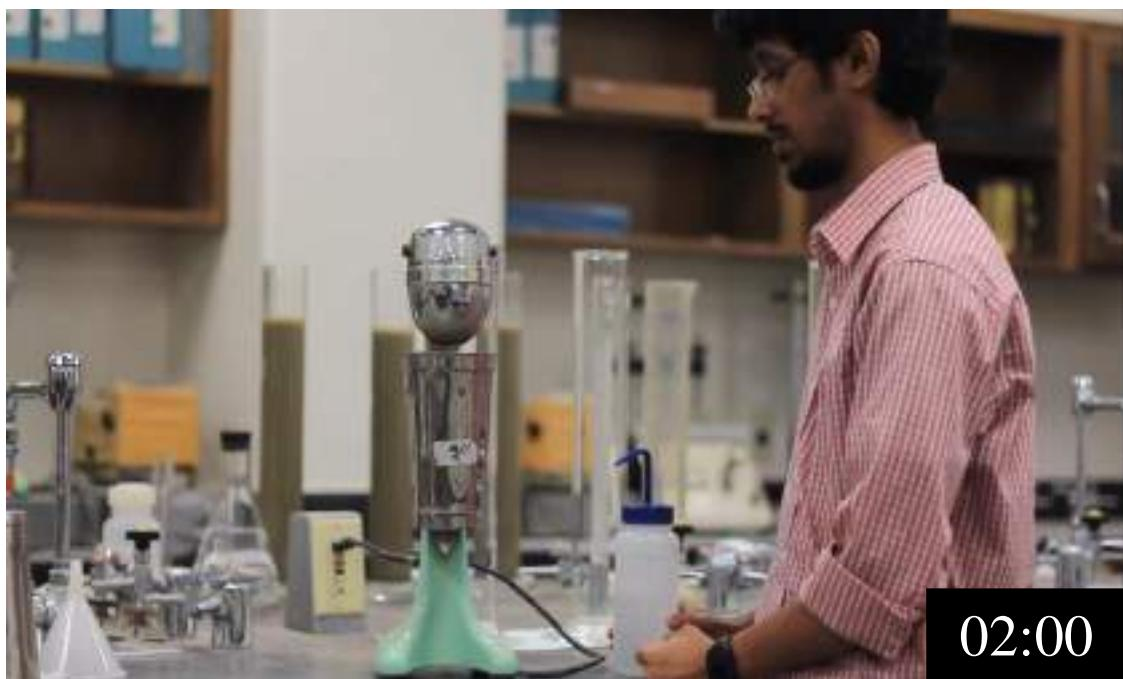
شکل ۳۷-۴: مخلوط کردن نمونه با مخلوط کن به مدت ۲ دقیقه
