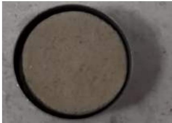
شکل ۵-۳۰: نمونه پس از خشک شدن در گرم کن بدون داشتن ترک
