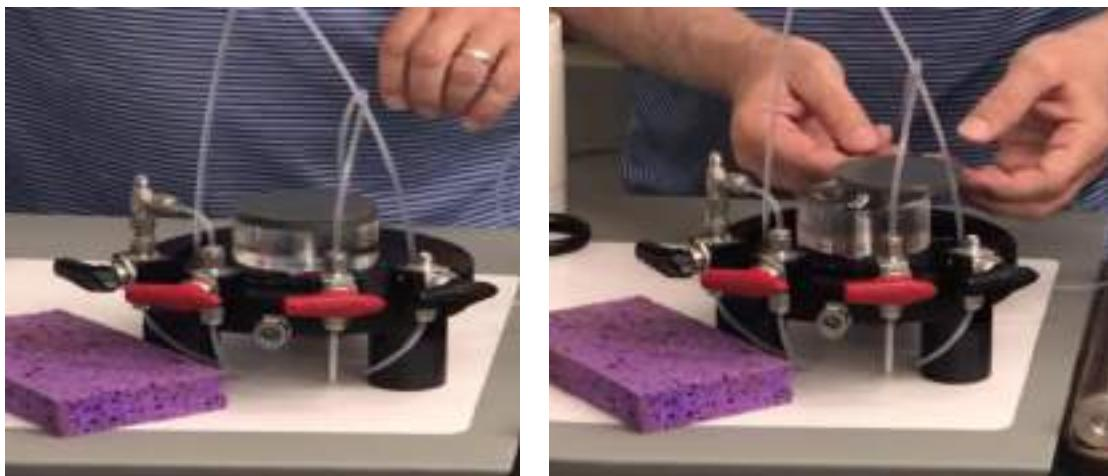
شکل ۴۶-۱۸: قرار دادن سنگ متخلخل روی کلاهک پایینی
