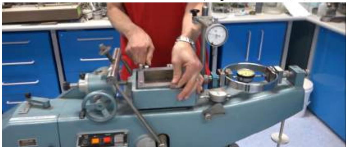
شکل ۳۲-۱۶: قرار دادن جعبه برش درون دستگاه برش مستقیم
