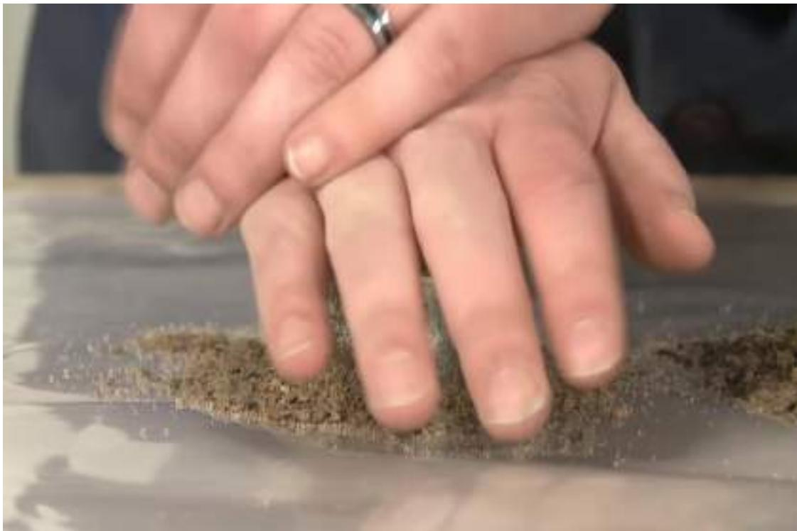
شکل ۷-۳۵: فشردن نمونه با دست به منظور متراکم کردن آن
