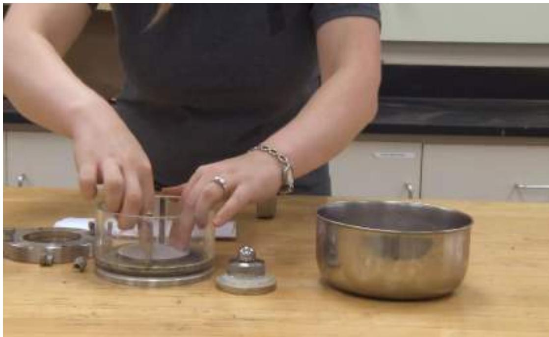
شکل ۱۴-۴۵: صاف کردن کاغذ صافی داخل سلول دستگاه تحکیم و از بین بردن حباب‌های هوایی ایجادشده
