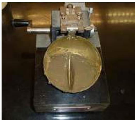
شکل ۵-۴: نمونه‌ای از شیار ایجادشده در جام برنجی
