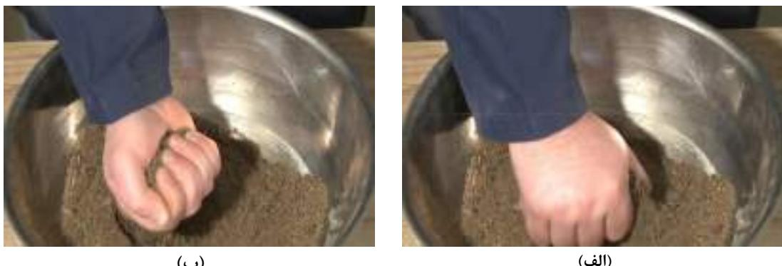
شکل ۷-۲۵: برداشتن و فشردن نمونه توسط دست به منظور بررسی مقدار رطوبت نمونه
