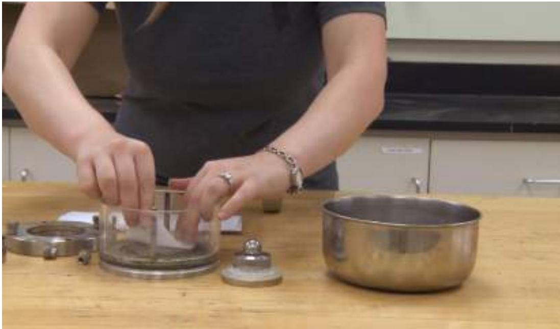
شکل ۴۴-۱۴: قرار دادن کاغذ صافی داخل سلول دستگاه تحکیم
