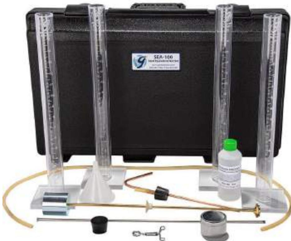
شکل ۷-۸: ست آزمایشگاهی آزمایش همارز ماسه
