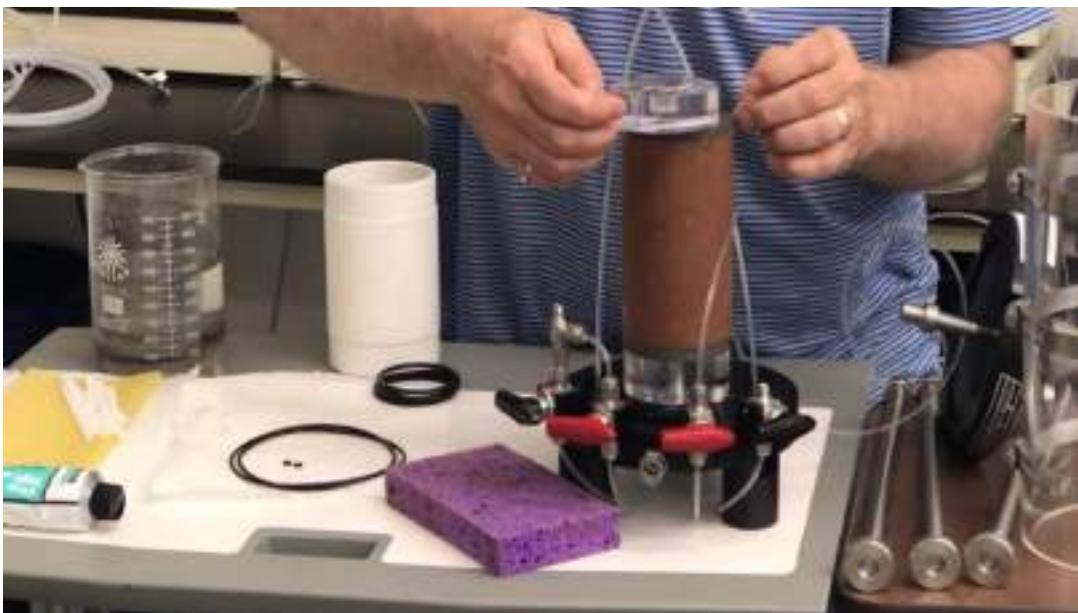
شکل ۴۹-۱۸: قرار دادن کلاهک بالایی بر روی
