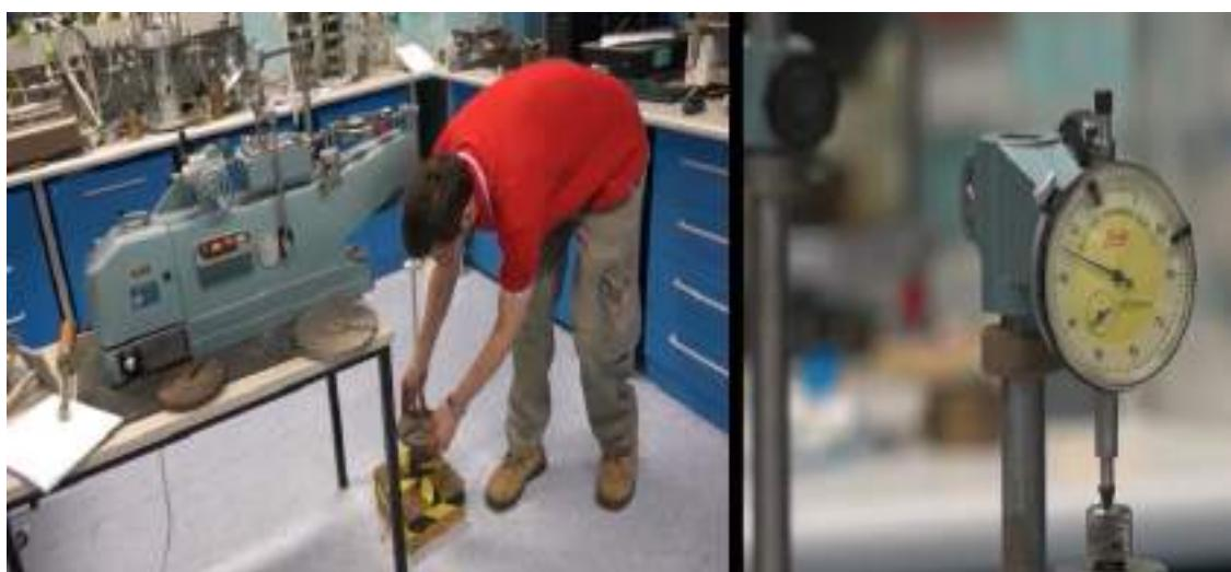
شکل ۴۵-۱۶: قرار دادن وزنه روی میله دوشاخه و ثبت تغییرات جابجایی قائم دستگاه
