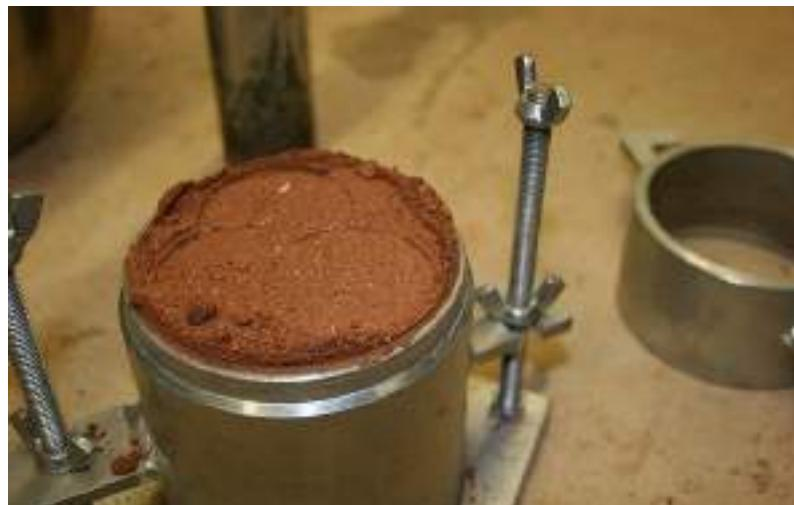
شکل ۱۷-۱۰: اتمام اجرای آخرین لایه تراکم و باز کردن حلقه بالایی
