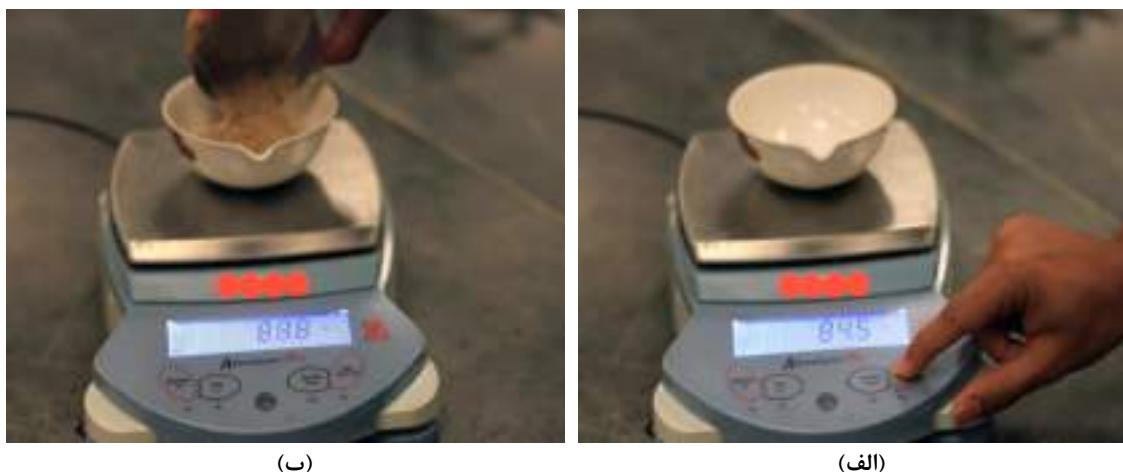
شکل ۳-۱۶: برداشتن مقدار ۱۰۰ گرم از نمونه خاک؛ (الف) صفر کردن ترازو؛ (ب) ریختن خاک درون ظرف تبخیر چینی
