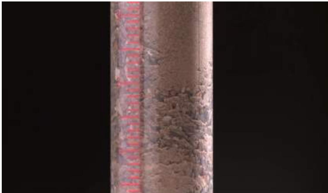
شکل ۷-۴۸: نمونه‌ای از ته‌نشینی نامطلوب ذرات ریزدانه در بین قسمت‌های درشت‌دانه مخلوط
