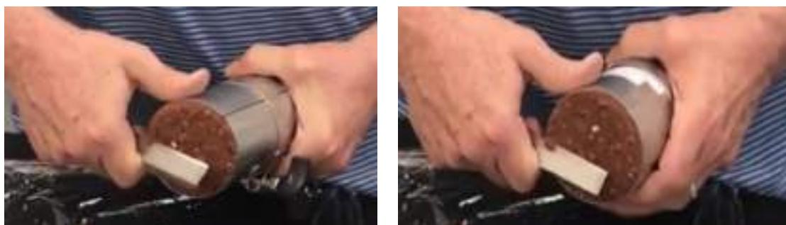
شکل ۳۶-۱۸: تراشیدن دور تادر سطح نمونه با کاتر تیز
