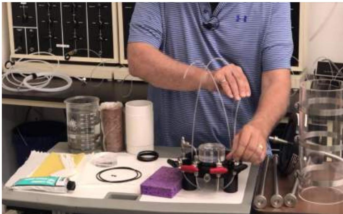
شکل ۴۳-۱۸: سفت کردن لوله‌های دستگاه سه‌محوری
