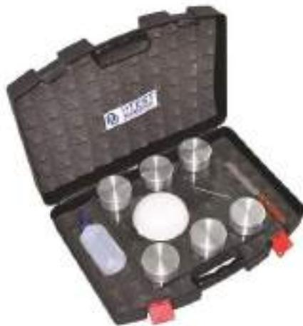
شکل ۵-۱۰: نمای کلی بخشی از تجهیزات آزمایش حد روانی شامل: ظروف تعیین رطوبت، ظرف چینی تعیین رطوبت، شیارکش، کاردک و بطری پلاستیکی
