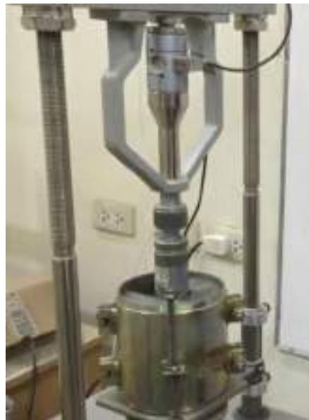
شکل ۱۳-۴۳: مماس کردن پیستون روی نمونه خاک
