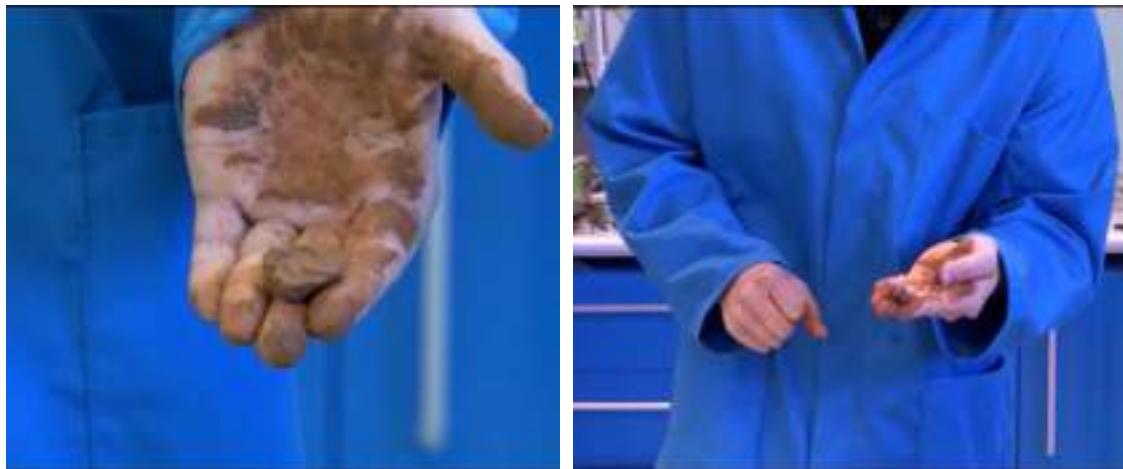
شکل ۱۹-۱: آزمایش اتساع
