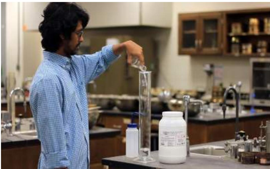
شکل ۳۰-۴: ریختن ۱۲۵ سی سی مخلوط ماده برآکنده‌ساز در استوانه مدرج
