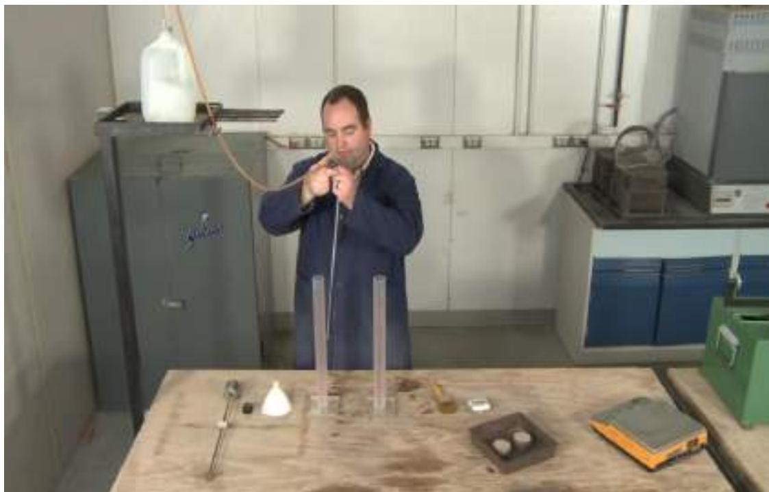
شکل ۷-۳۹: قراردادن گالن و ملحقات آن در ارتفاع مذکور و برداشتن گیره از لوله پلاستیکی و پر کردن استوانه به میزان ۴ لیتر
