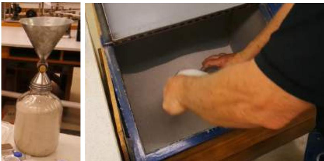
شکل ۱۰-۱۲: پر کردن بطری مخروط ماسه از ماسه اتاوا (مبنا)
