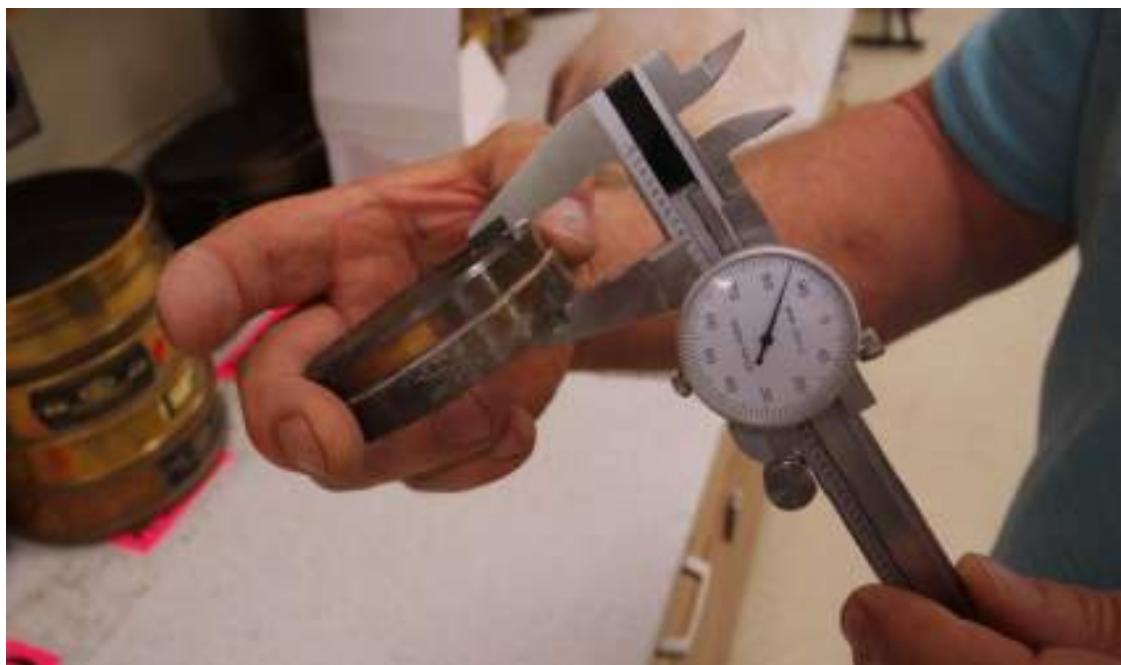
شکل ۱۵-۱۵: اندازه‌گیری ارتفاع حلقه برنجی توسط کولیس
