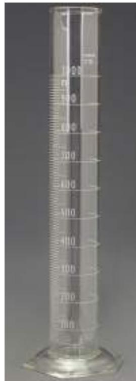
شکل ۳-۳: استوانه مدرج به حجم ۱۰۰۰ سی سی
