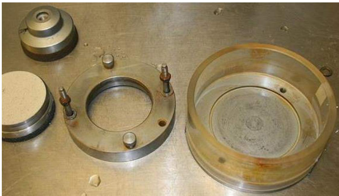
شکل ۹-۱۵: حلقه فلزی و ملحقات دستگاه تحکیم
