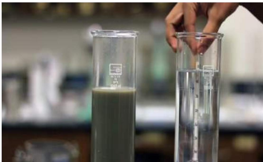
شکل ۴۱-۴: قرار دادن استوانه حاوی نمونه در کنار استوانه مرحله شماره ۵ (شکل سمت راست، محلول شاهد)
