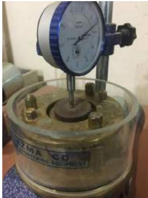
شکل ۱۶-۱۵: دستگاه تورم آماده آزمایش با قرارگیری نمونه وزنه معادل ۱ کیلو پاسکال روی آن
