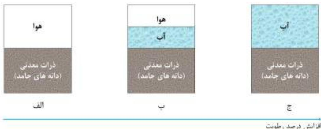
شکل ۲۳-۵: روند اشباع شدن خاک تا رسیدن به حد انقباض: (الف) در حالت خشک؛ (ب) در حالت نیمه اشباع؛ (ج) در حالت اشباع کامل (SL).
