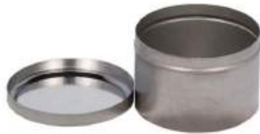
شکل ۷-۳: پیمانه فلزی
