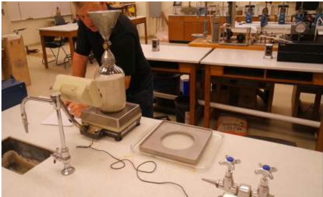
شکل ۱۲-۱۶: تعیین جرم بطری به همراه مخروط و ماسه درون آن
