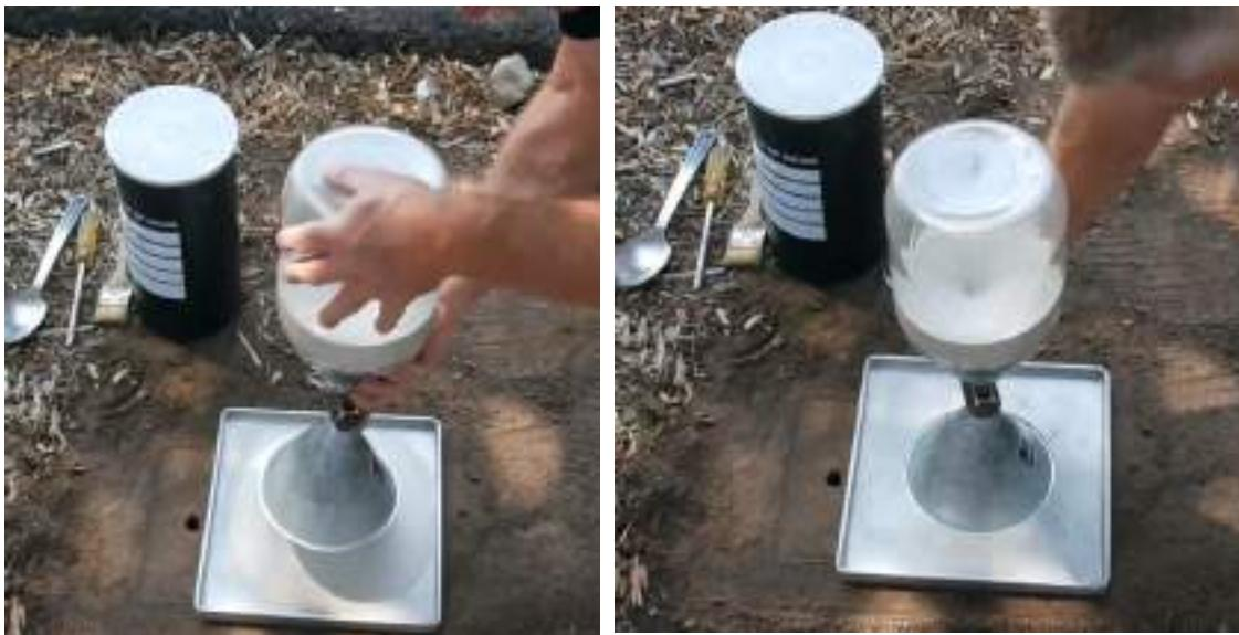
شکل ۲۳-۱۲: بستن شیر مخروط ماسه و برداشتن آن
