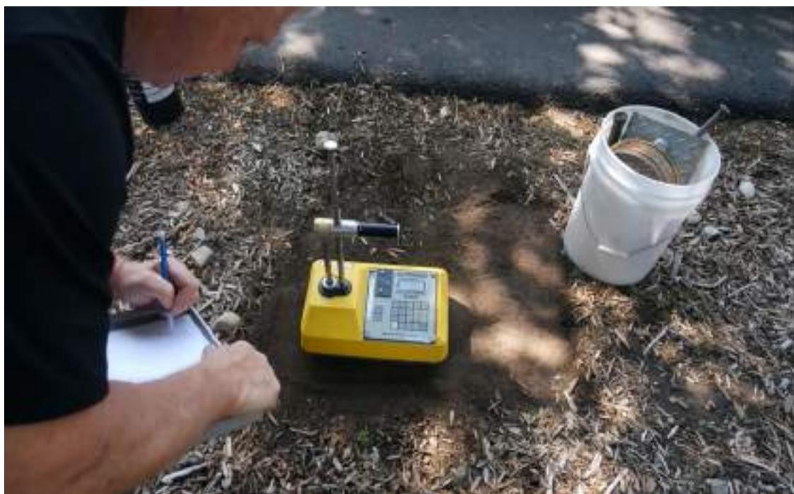
شکل ۴۱-۱۲: ثبت نتایج دستگاه پس از گذشت یک دقیقه
