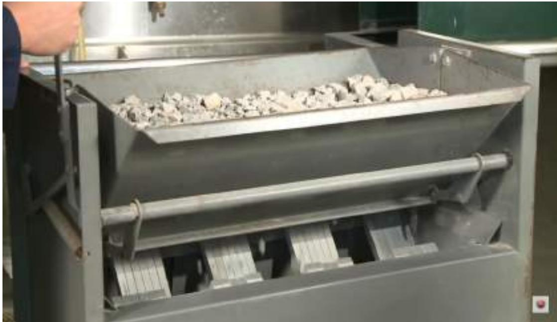
شکل ۱۹-۷: عبور نمونه خاک از دستگاه جداساز نمونه
