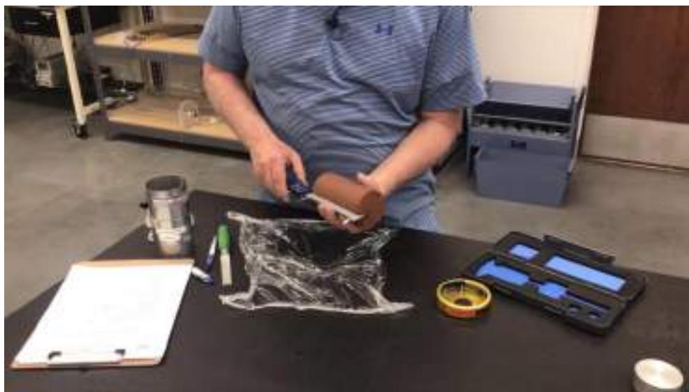
شکل ۴۰-۱۸: اندازه‌گیری ارتفاع نمونه توسط کولیس
