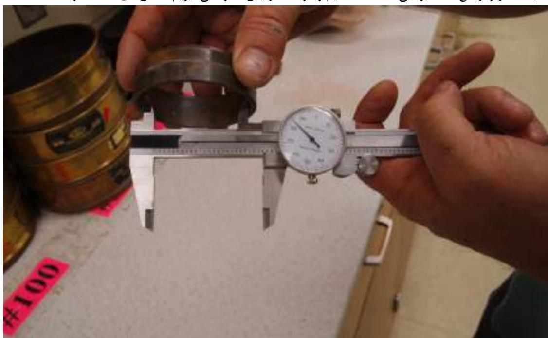
شکل ۱۴-۱۵: اندازه‌گیری قطر حلقه برنجی توسط کولیس
