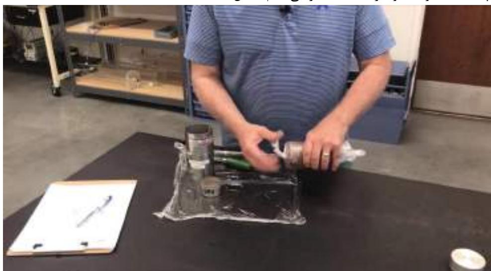
شکل ۳۲-۱۸: باز کردن پلاستیک اطراف نمونه
