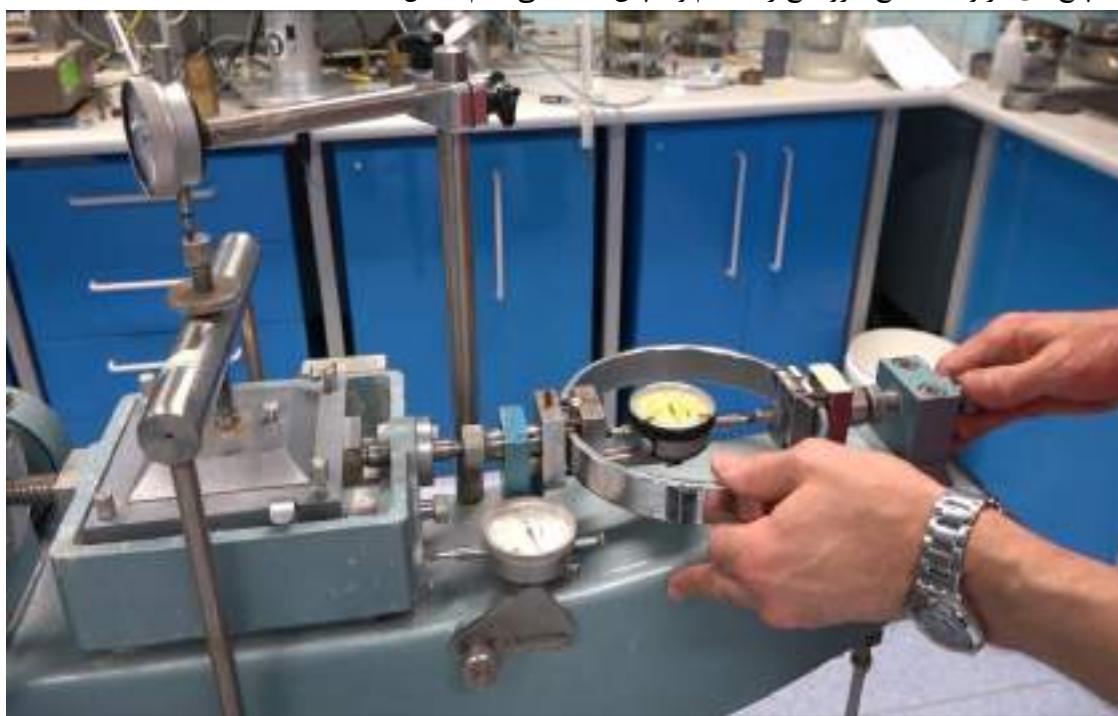
شکل ۴۱-۱۶: تنظیم کردن و سفت کردن پیچ‌های گیج نیروسنجه
