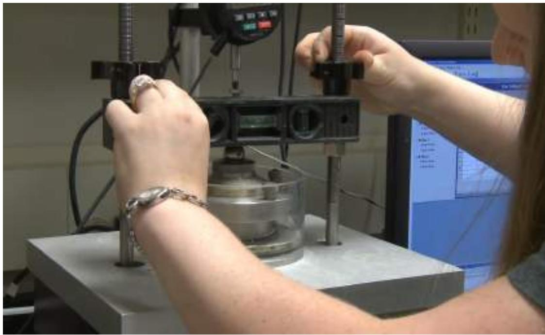
شکل ۱۴-۵۹: تراز کردن میله افقی توسط تنظیم دوباره پیچ‌ها
