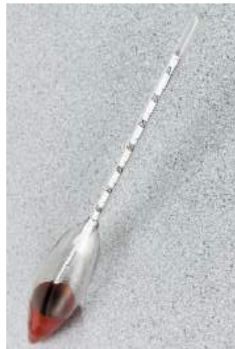
شکل ۴-۱۵: هیدرومتر از نوع ASTM 152-H
