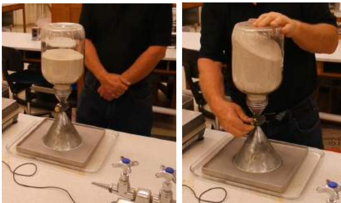
شکل ۱۷-۱۲: باز کردن شیر مخروط ماسه و پر شدن مخروط آن
