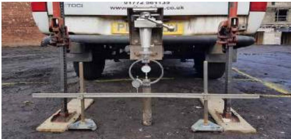
شکل ۴۷-۱۳: انجام آزمایش CBR در محل
