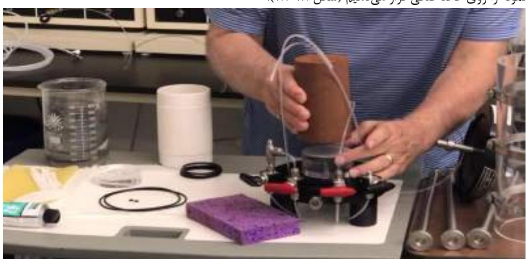
شکل ۴۸-۱۸: قرار دادن نمونه روی کاغذ صافی
