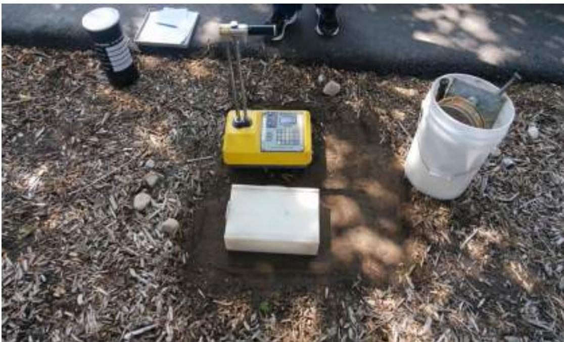
شکل ۳۴-۱۲: قرار دادن بلوک استاندارد روی سطح زمین
