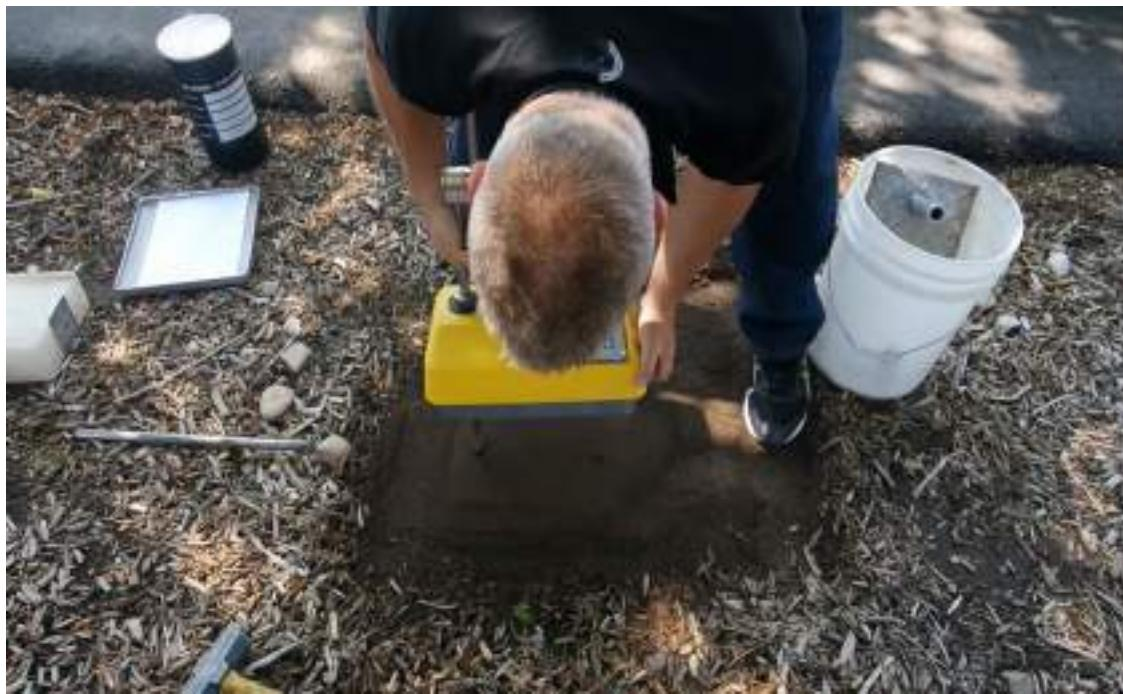
شکل ۴۰-۱۲: وارد کردن میله دستگاه به زمین
