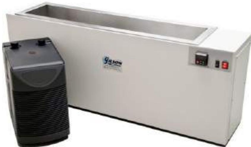
شکل ۱۹-۴: ظرف جهت ثابت نگهداشتن درجه حرارت
