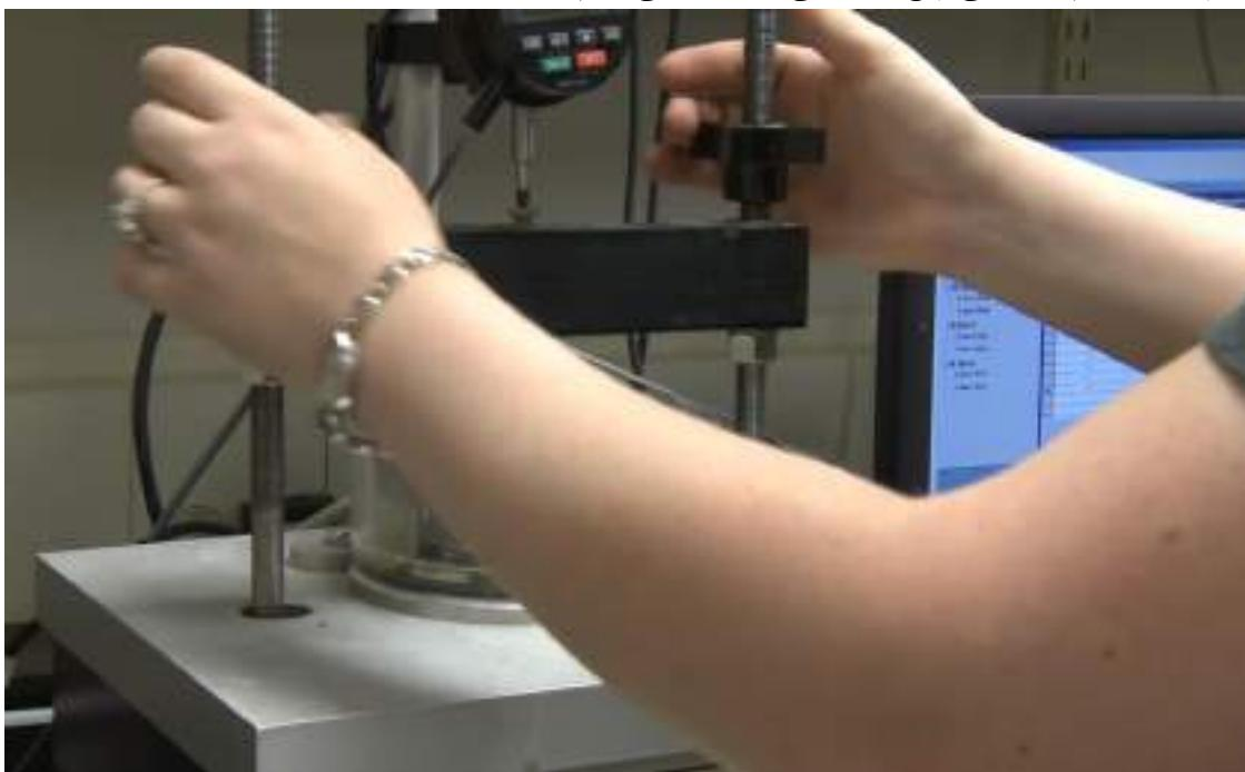
شکل ۱۴-۵۷: بستن پیچ‌های بالایی دستگاه
