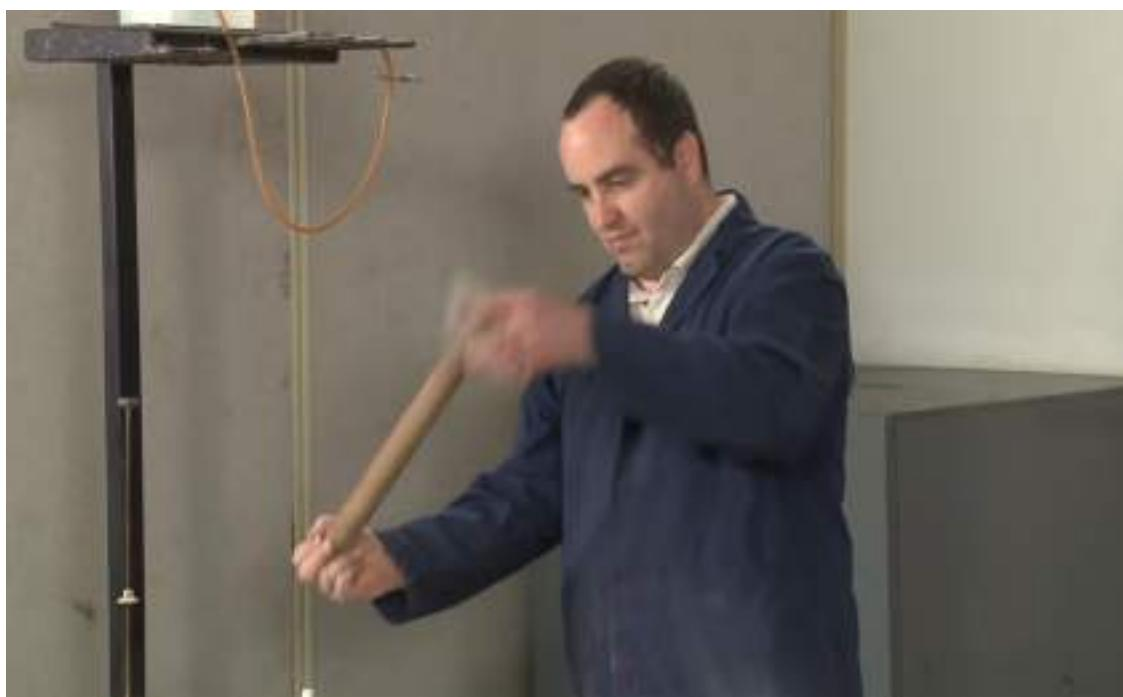
شکل ۷-۴۳: سروته کردن استوانه و تکان دادن دستی آن به منظور آزادسازی نمونه تهنشین شده
