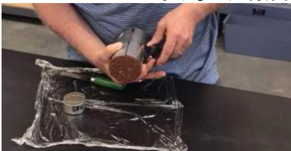
شکل ۳۵-۱۸: سفت کردن پیچ استوانه اصلاح کننده
