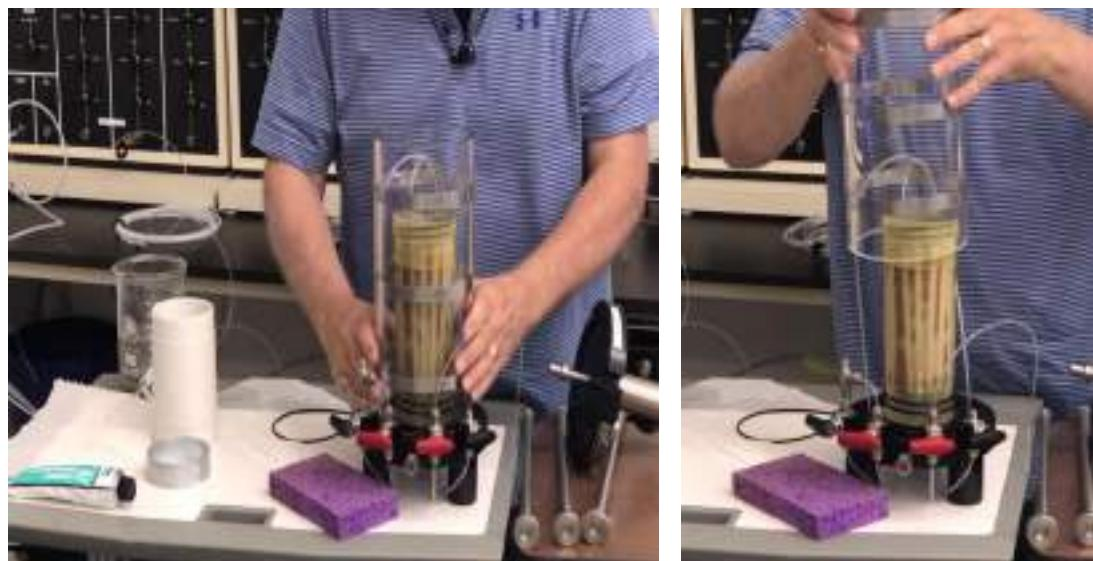
شکل ۶۲-۱۸: قرار دادن استوانه شفاف روی سلول سه محوری
