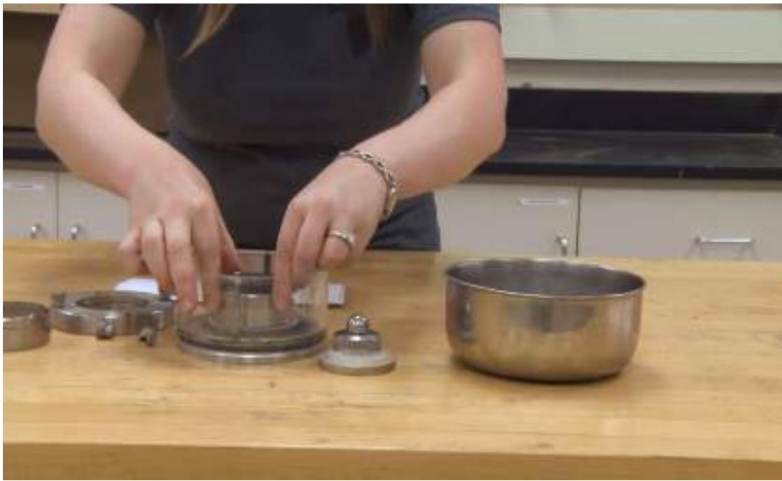
شکل ۱۴-۵۰: قرار دادن سنگ متخلخل بالایی روی کاغذ صافی داخل سلول دستگاه تحکیم
