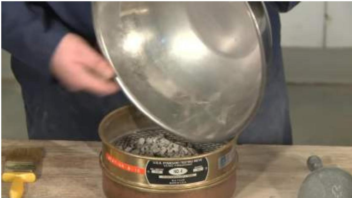
شکل ۲۰-۷: ریختن نمونه به داخل الک شماره ۴
