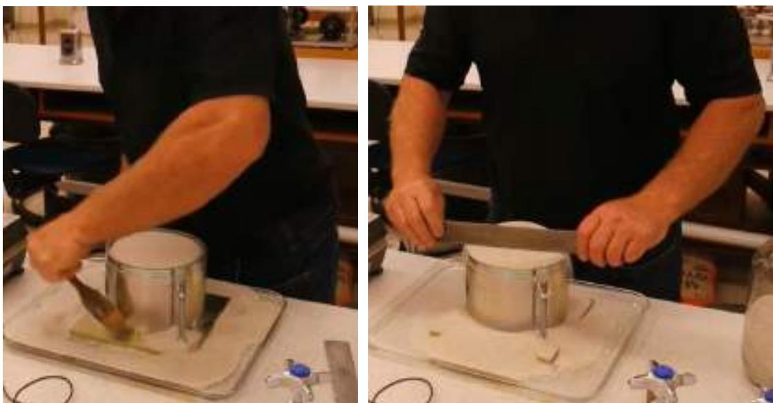
شکل ۱۵-۱۲: صاف کردن سطح ماسه و تمیز کردن اطراف قالب
