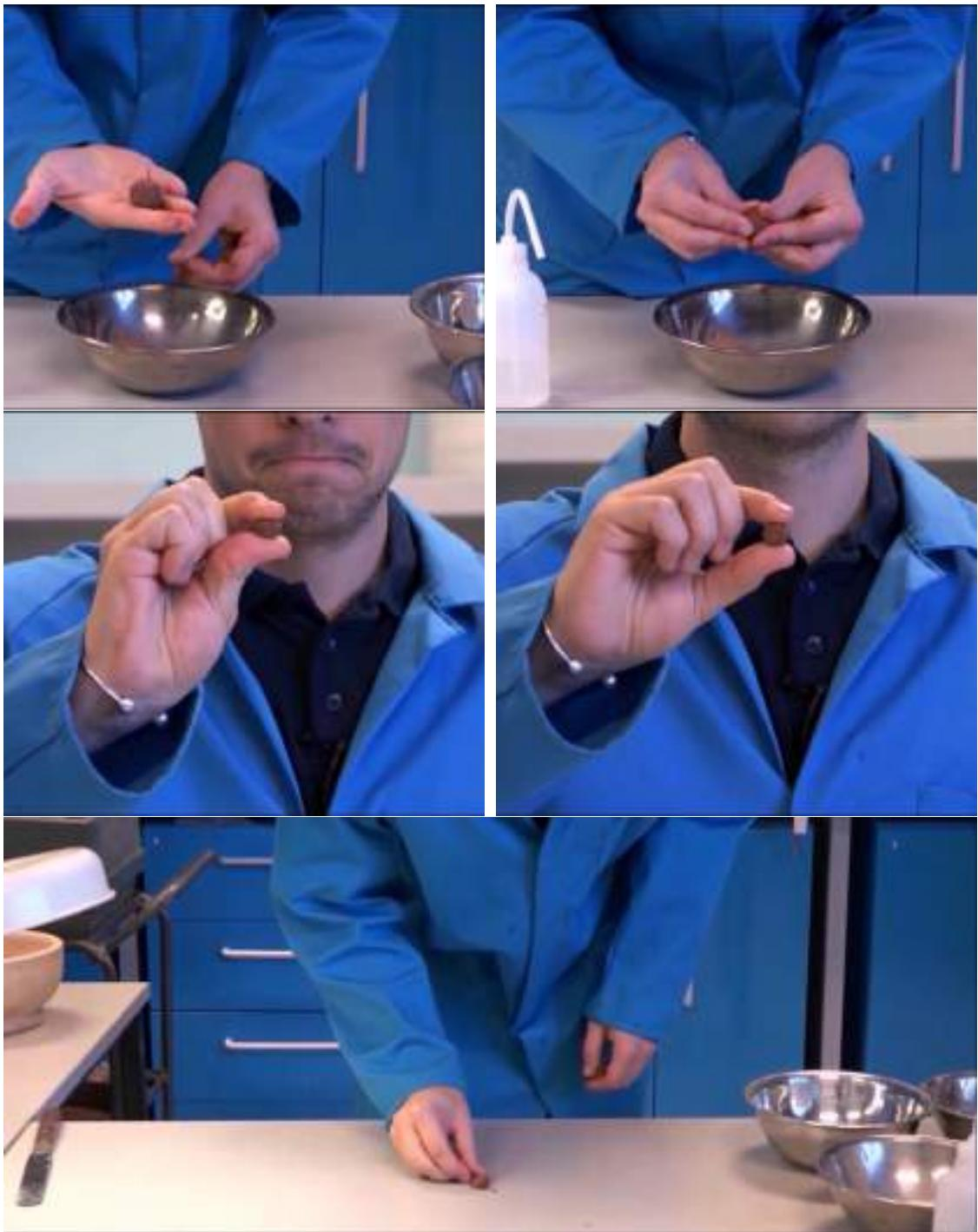
شکل ۱-۱۸: آزمایش مقاومت خشک
