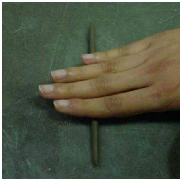
شکل ۱۹-۵: فتیله کردن نمونه ساخته شده از مرحله ۴
