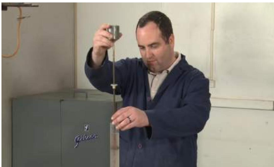
شکل ۵۰-۷: وارد نمودن سنبه فولادی به داخل مخلوط جهت قرائت ماسه
