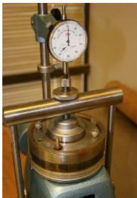
شکل ۳۵-۱۴: دستگاه تحکیم حین آزمایش
