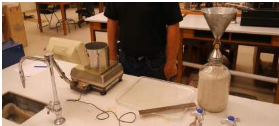
شکل ۱۱-۱۲: اندازه‌گیری جرم قالب تراکم بدون خاک توسط ترازو
