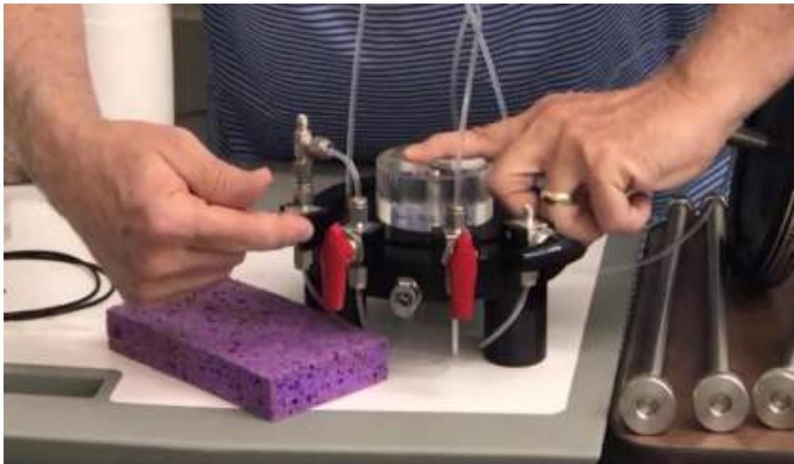
شکل ۴۴-۱۸: خالی کردن هوای لوله‌های دستگاه توسط عبور دادن جریان آب
