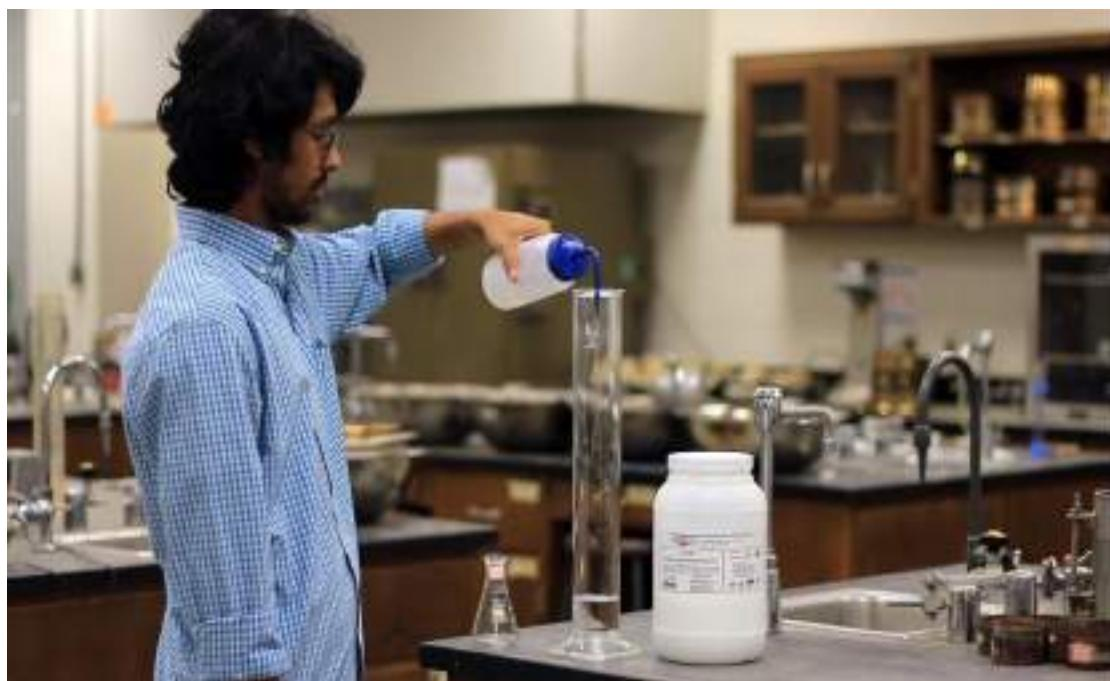
شکل ۳۱-۴: افزودن ۸۷۵ سی سی آب مقطر به استوانه مدرج
