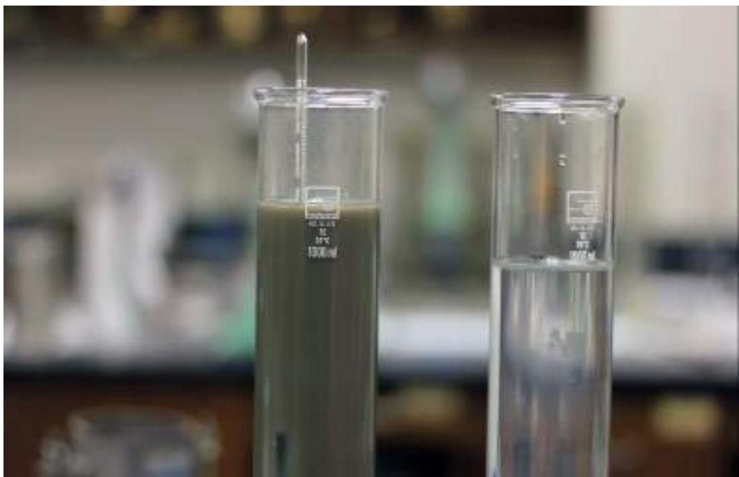
شکل ۴-۴: قراردادن هیدرومتر در استوانه حاوی نمونه
