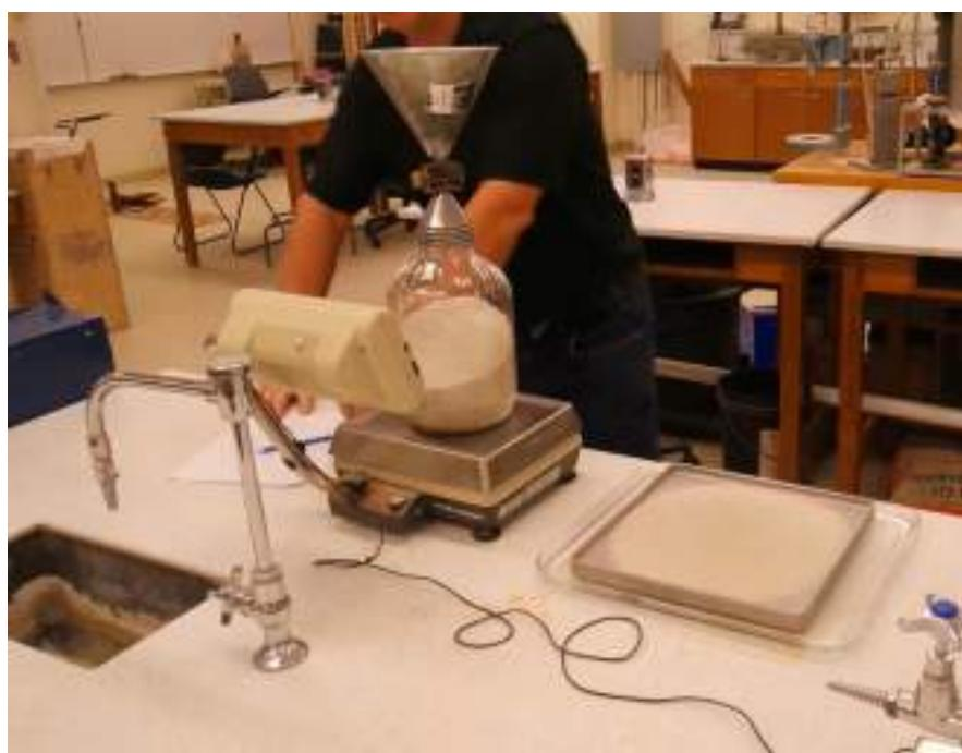
شکل ۱۸-۱۲: برداشتن مخروط ماسه و اندازه‌گیری جرم آن توسط ترازو
