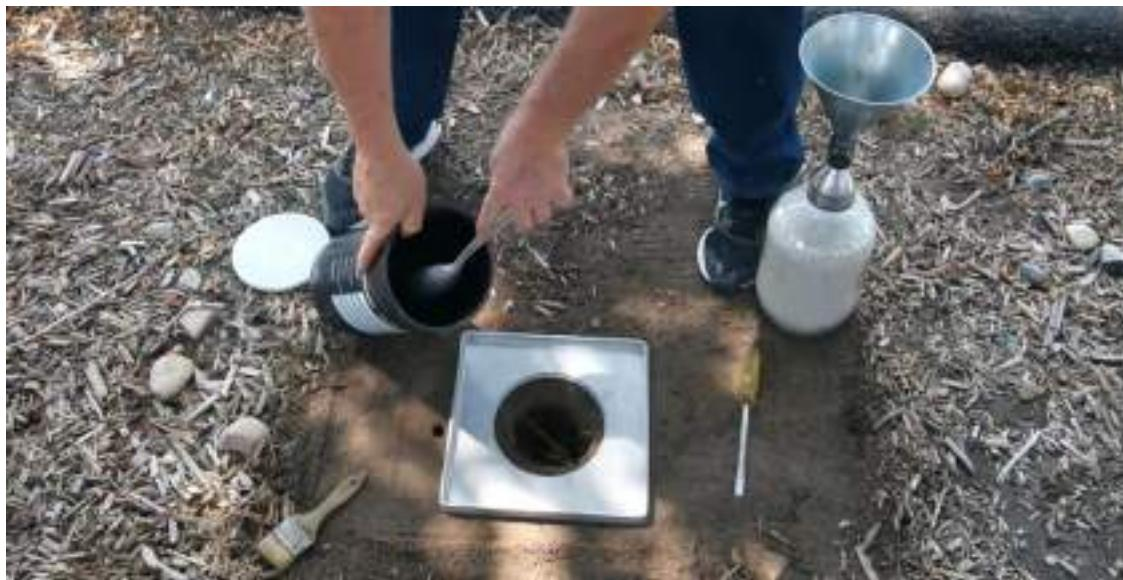
شکل ۲۱-۱۲: ریختن نمونه داخل ظرف فلزی بزرگ جهت انتقال به آزمایشگاه
