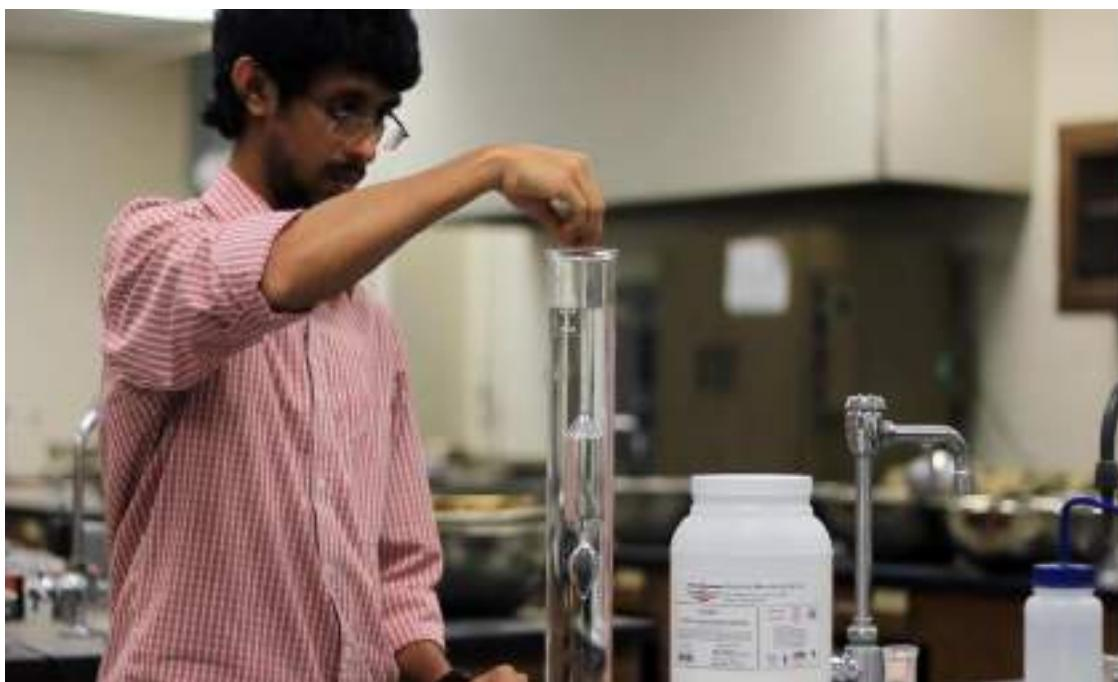
شکل ۳۳-۴: قراردادن هیدرومتر در استوانه مدرج مرحله ۵ ( محلول شاهد )
