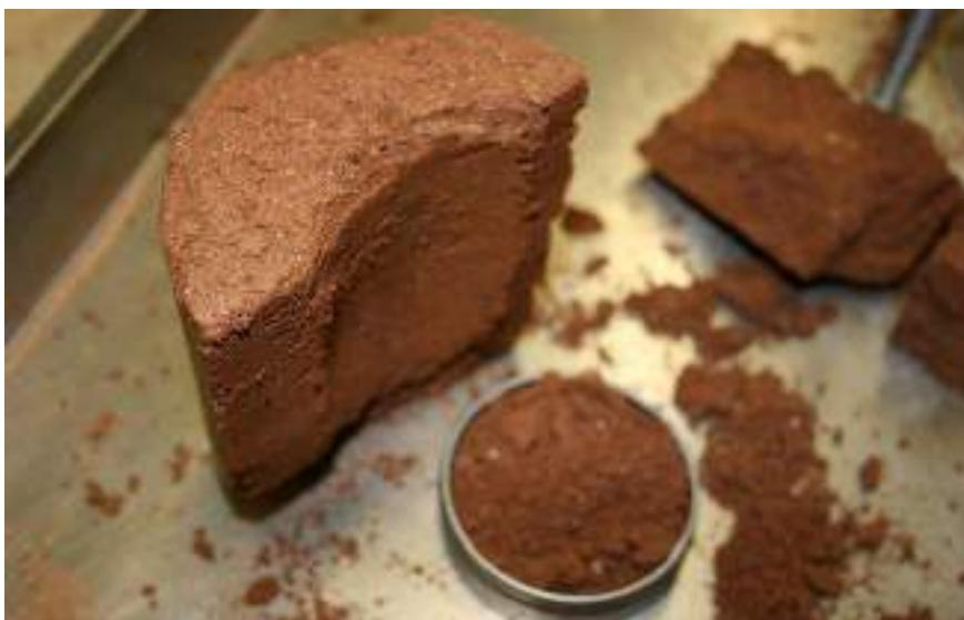
شکل ۱۰-۲۰: نمونه‌گیری از خاک متراکم شده جهت تعیین درصد رطوبت
