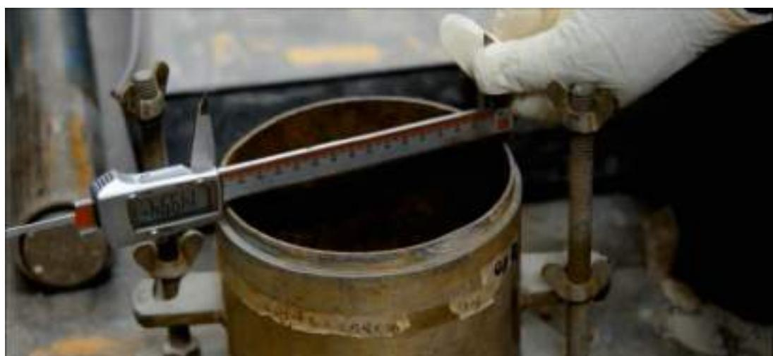
شکل ۲۹-۱۳: اندازه‌گیری قطر قالب تراکم توسط کولیس
