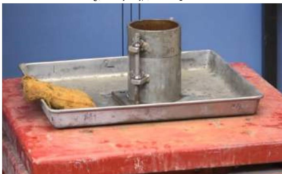
شکل ۱۹-۱۱: ارتعاش قالب روی میز ارتعاش مکانیکی بدون سربار
