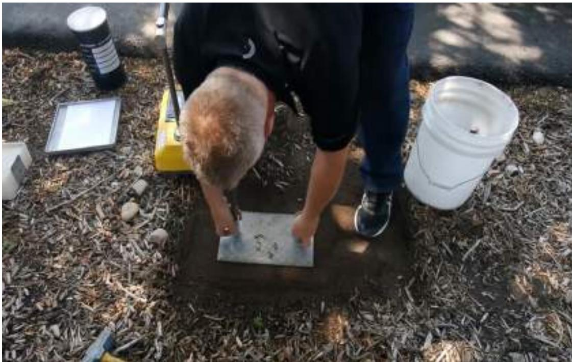
شکل ۳۹-۱۲: برداشتن صفحه خراش‌دهنده و میله حفاری
