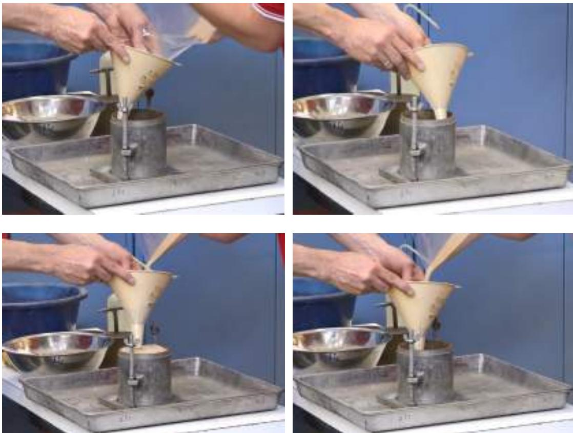
شکل ۱۳-۱۱: ریختن ماسه داخل قالب از طریق قیف
