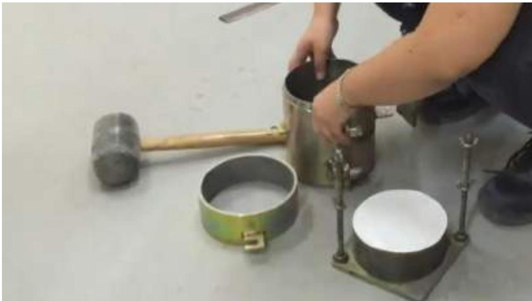
شکل ۳۵-۱۳: قرار دادن دیسک در کف قالب تراکم و کاغذ صافی روی دیسک
