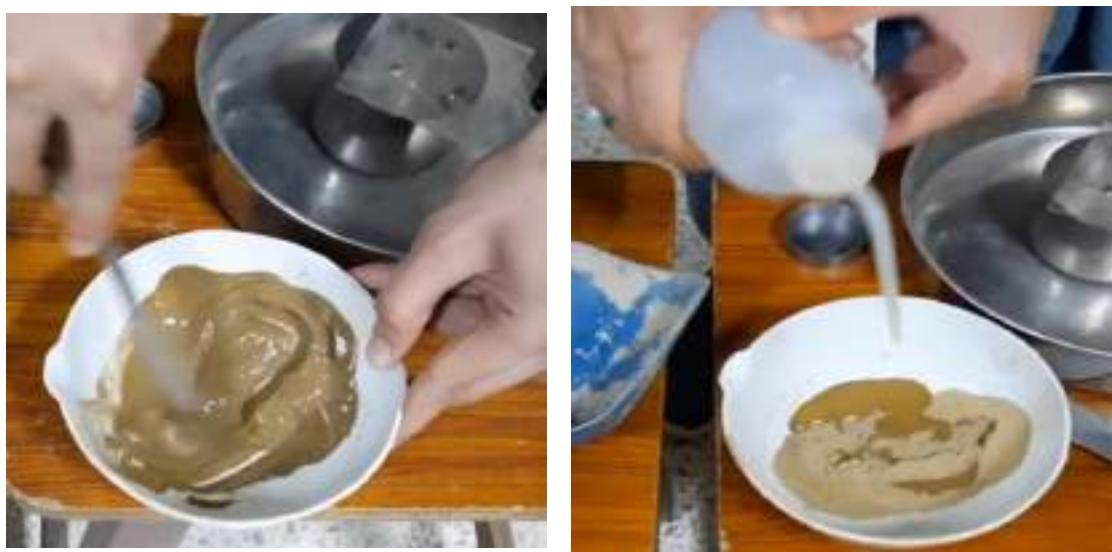
شکل ۲۶-۵: مخلوط کردن آب و نمونه توسط کاردک
