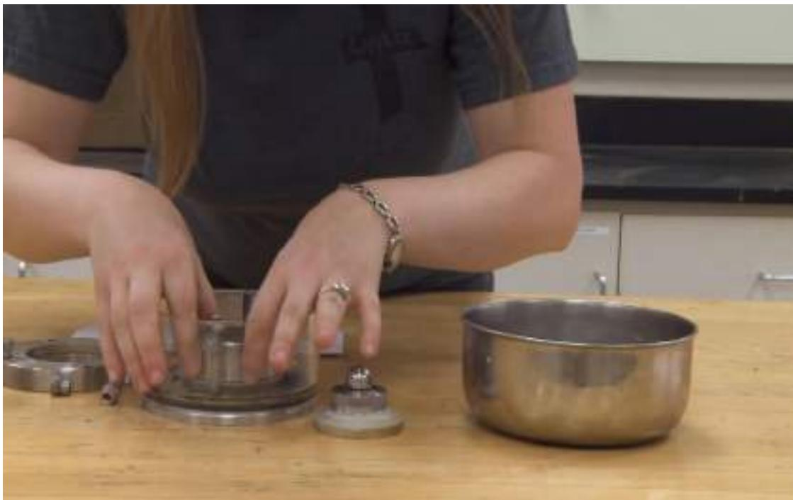
شکل ۴۷-۱۴: قرار دادن نمونه روی کاغذ صافی در سلوول دستگاه تحکیم از نمای جانبی
