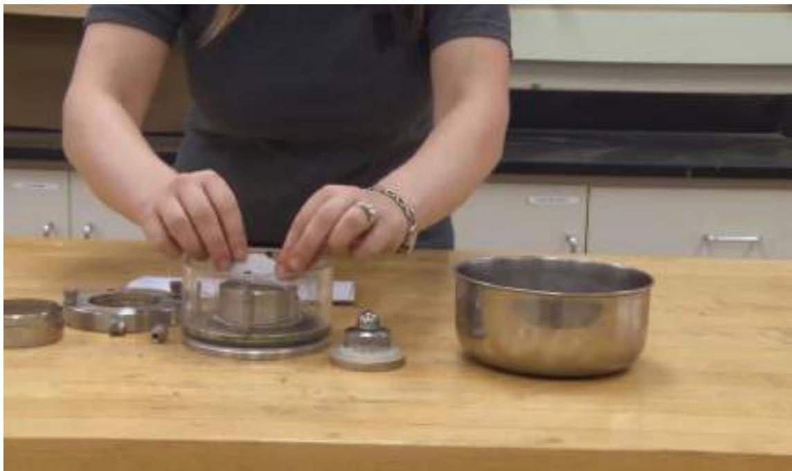
شکل ۴۹-۱۴: قرار دادن کاغذ صافی بالایی روی نمونه داخل سلول دستگاه تحکیم
