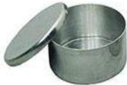
شکل ۱۴-۱۰: ظرف تعیین درصد رطوبت
