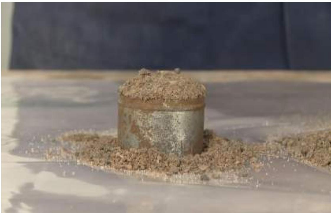
شکل ۷-۳۶: شکل حاصله پس از متراکم کردن نمونه
