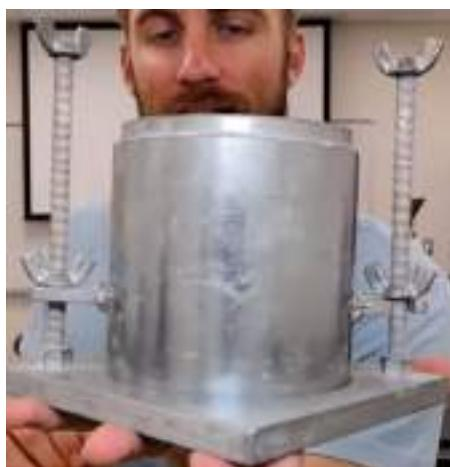
شکل ۱۲-۵: قالب تراکم (پروکتور) بدون حلقه
