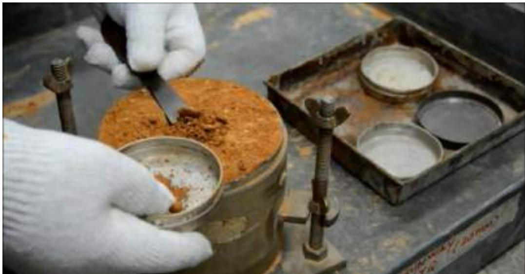
شکل ۴۴-۱۳: تهیه نمونه جهت تعیین درصد رطوبت خاک پس از نفوذ سنبه
