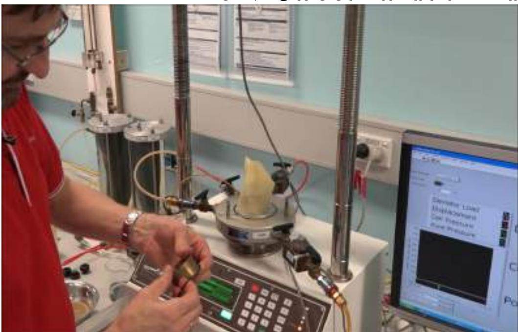
شکل ۶۹-۱۸: قرار دادن اورینگ روی ابزار مخصوص آن جهت انتقال آن به دور نمونه
