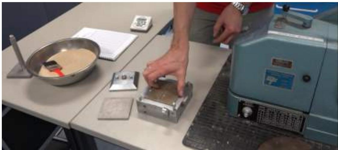
شکل ۳۱-۱۶: قرار دادن سنگ متخلخل درون جعبه برش مستقیم
