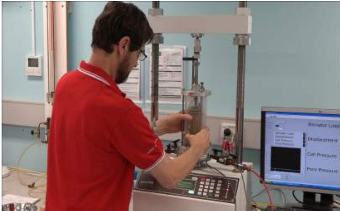
شکل ۸۲-۱۸: قرار دادن پیستون
