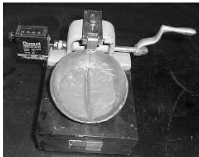
شکل ۱۵-۵: شیار بسته شده در طول بیش از ۵/۰ اینچ
