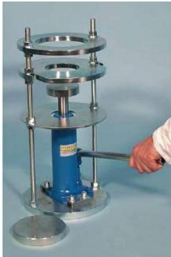
شکل ۱۴-۱۳: جک هیدرولیکی
