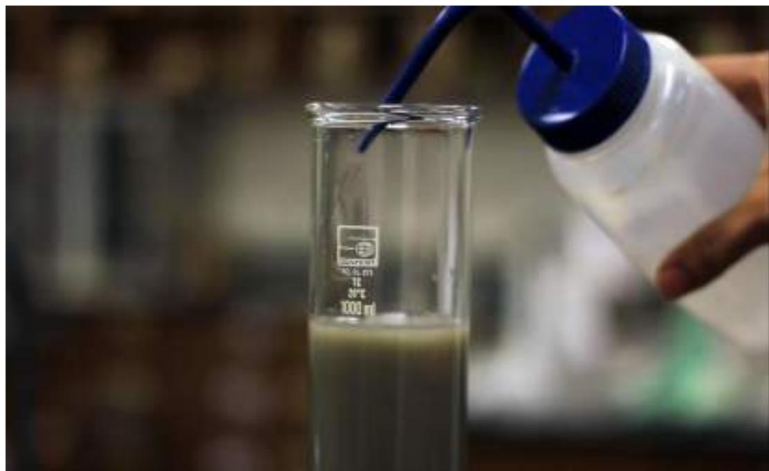
شکل ۴-۳۹: پر کردن استوانه حاوی نمونه با آب مقطر تا علامت ۱۰۰۰ سی سی
