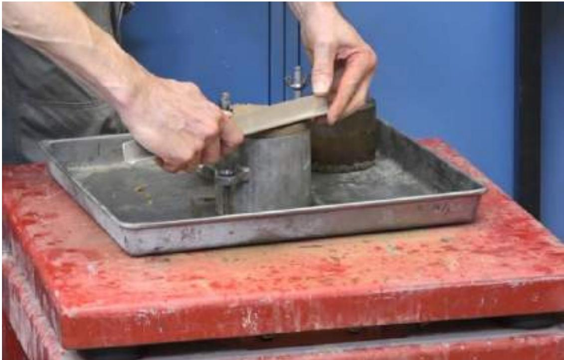
شکل ۲۳-۱۱: صاف کردن سطح خاک با استفاده از لبه صاف کن
