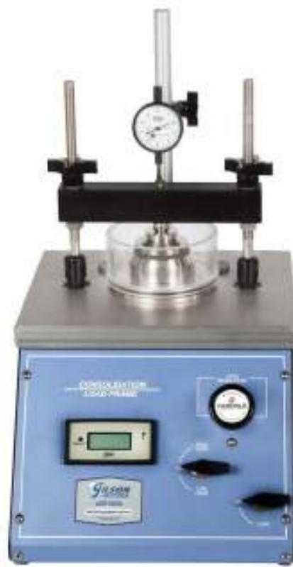
شکل ۲۲-۱۴: نوع اتوماتیک دستگاه آزمایش تحکیم یکبعدی
