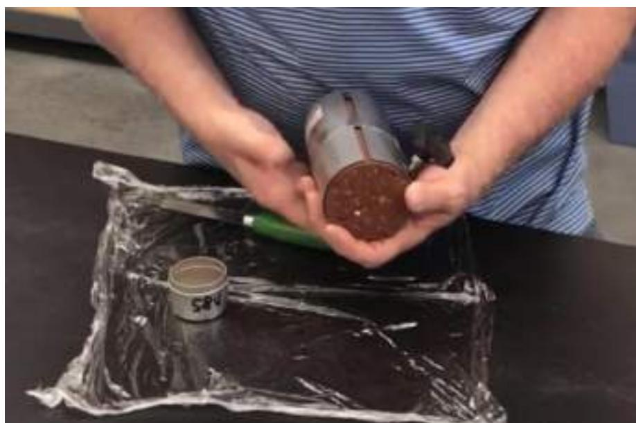
شکل ۳۴-۱۸: فاصله دادن نمونه از لبه استوانه اصلاح‌کننده
