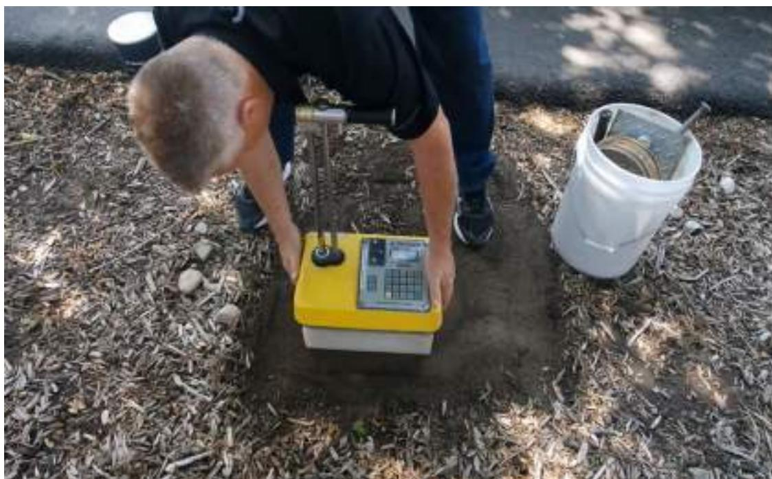
شکل ۳۵-۱۲: اندازه‌گیری دانسیته بلوک استاندارد در محل
