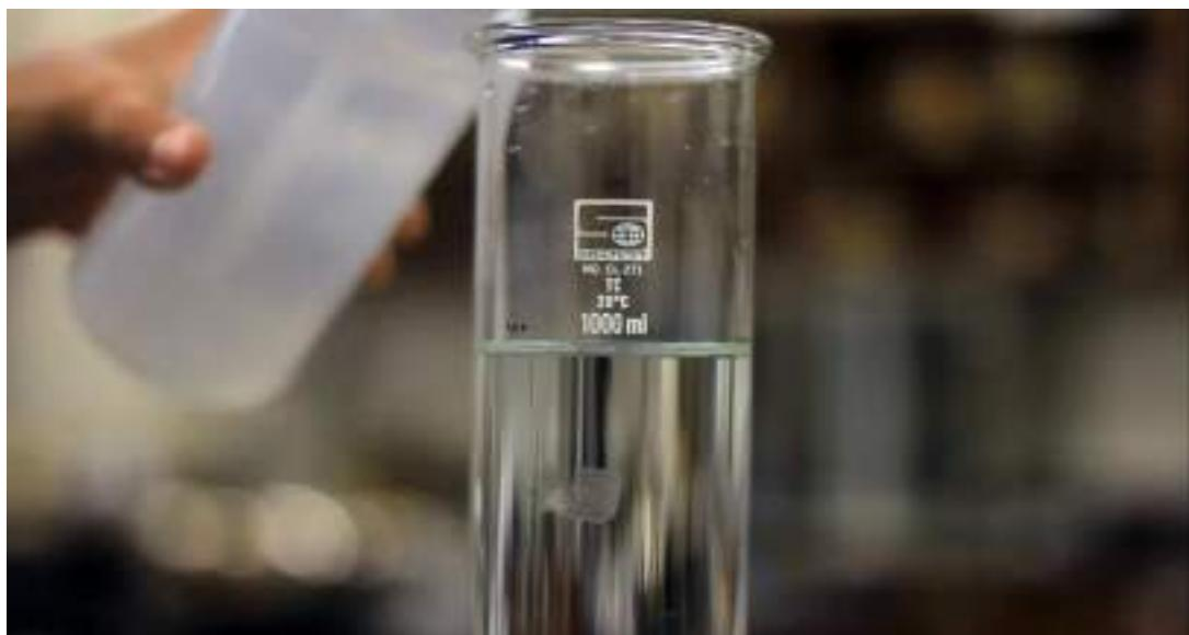
شکل ۳۲-۴: پر کردن استوانه مدرج تا مقدار ۱۰۰۰ سی سی ( محلول شاهد )
