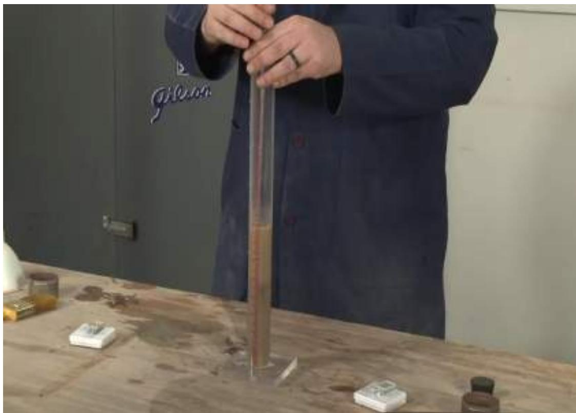
شکل ۷-۴۶: وارد کردن ضربه توسط لوله آبیاری و انتقال محلول تهیه شده در مرحله ۱۴ به مخلوط جهت جداسازی نمونه
