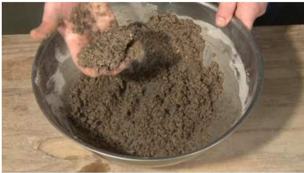
شکل ۷-۲۸: شکل به دست آمده از نمونه خیلی مرطوب و وجود آب آزاد پس از باز کردن دست
