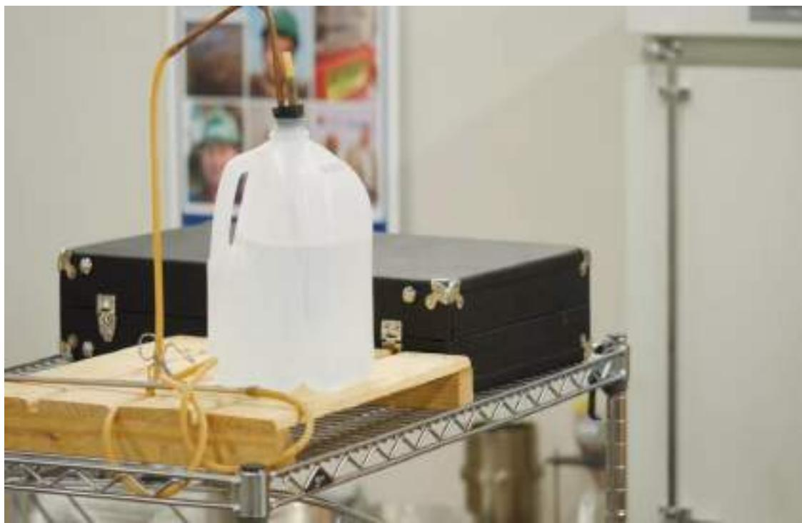
شکل ۷-۳۸: قراردادن سیفون و لوله‌های مذکور بر روی درپوش گالن حاوی محلول تهیه شده در مرحله ۱۴
