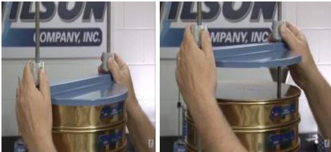
شکل ۹-۴: بستن درپوش ظرف و قرار دادن در دستگاه لرزاننده
