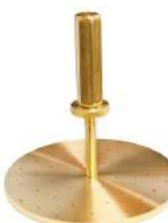
شکل ۲۷-۱۳: وزنه بالایی مخصوص
