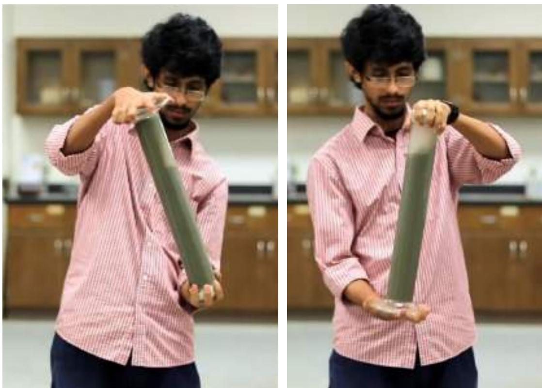
شکل ۱۰-۸: تکان دادن استوانه بسته شده با درپوش به صورت رفت و برگشت
