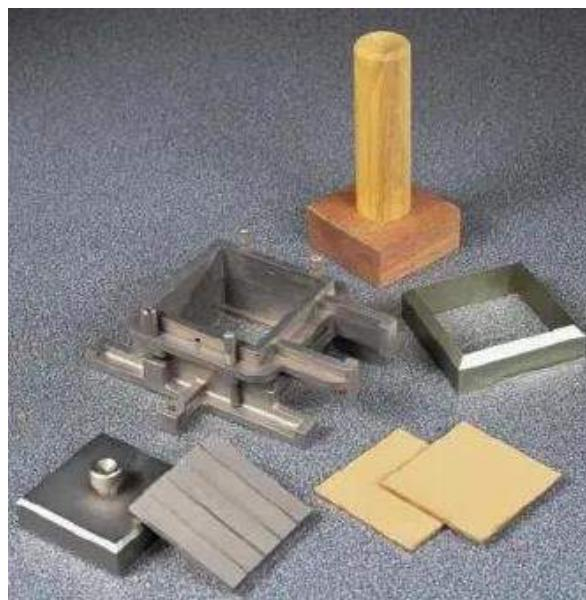
شکل ۸-۱۶: نمونه‌ای از جعبه برش مربعی و تجهیزات
