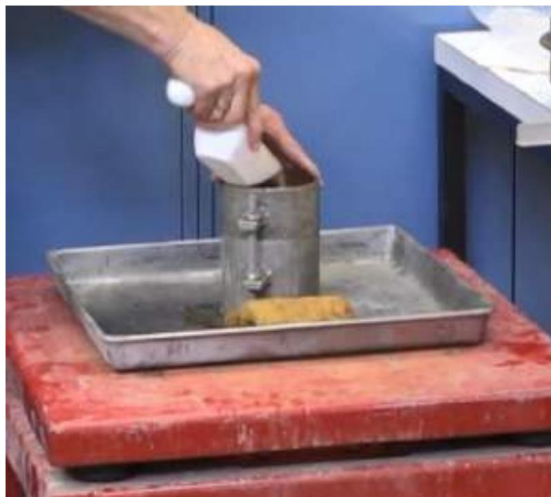
شکل ۲۱-۱۱: اضافه کردن خاک به قالب، حین ارتعاش روی میز ارتعاش مکانیکی
