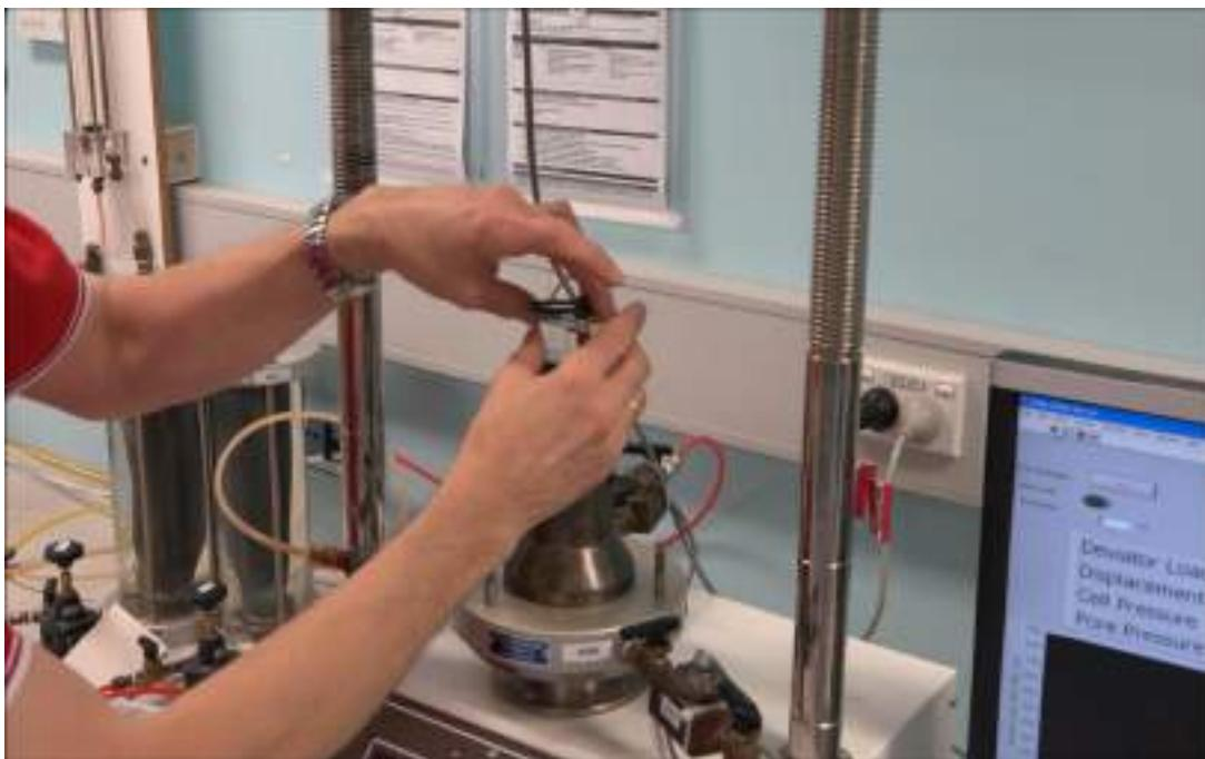
شکل ۱۸-۷۸: قرار دادن کلاهک بالایی روی نمونه
