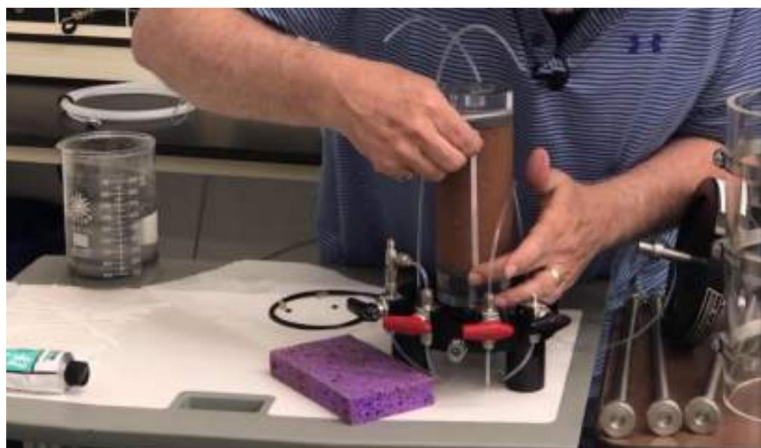
شکل ۱۸-۵۴: قرار دادن کاغذ صافی نواری روی نمونه
