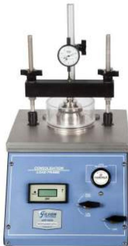
شکل ۲-۱۵: نوع اتوماتیک دستگاه آزمایش تحکیم یکبعدی
