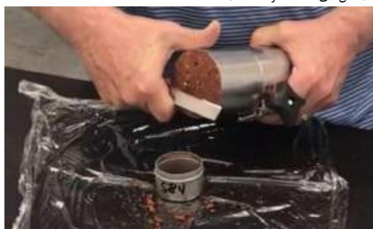
شکل ۳۷-۱۸: بریدن قسمت میانی نمونه به صورت قطری
