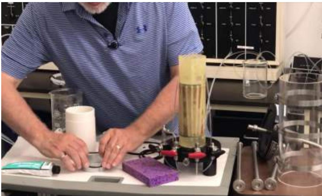
شکل ۵۷-۱۸: قرار دادن اورینگ روی ابزار مخصوص آن جهت انتقال آن به دور نمونه
