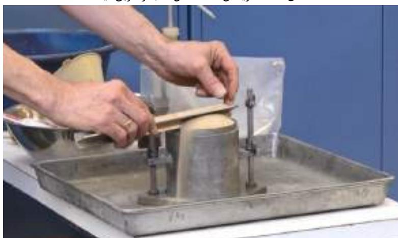
شکل ۱۴-۱۱: صاف کردن سطح ماسه با لبه‌صفاف کن (خطکش فلزی)
