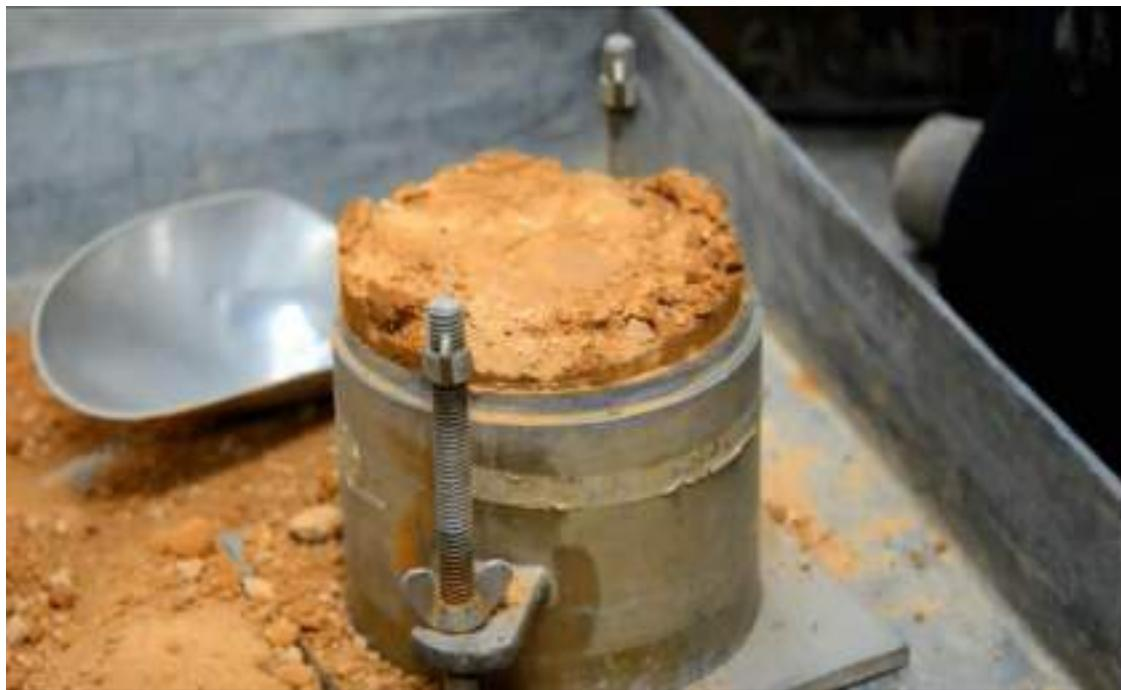
شکل ۳۸-۱۳: سطح خاک پس از برداشتن حلقه بالایی قالب تراکم
