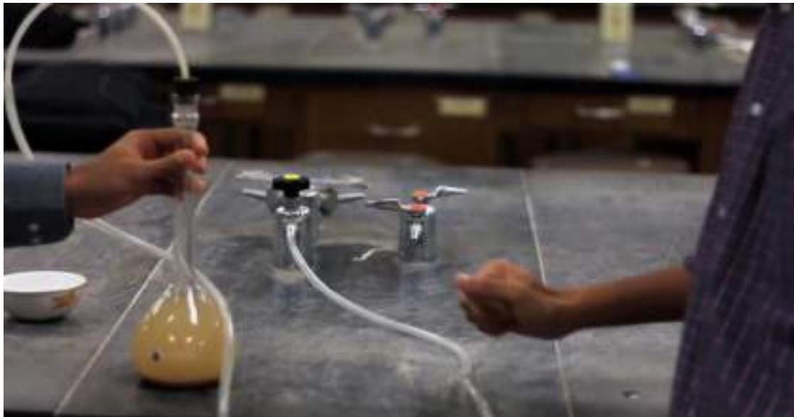
شکل ۱۹-۳: خارج کردن هوای موجود در داخل نمونه آب- خاک
