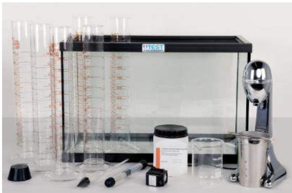
شکل ۲۵-۴: شکل کلی وسایل مورد نیاز برای آزمایش هیدرومتری
