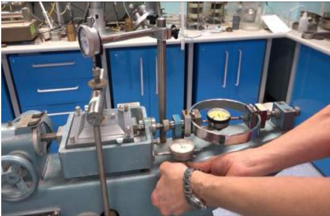
شکل ۴۲-۱۶: سفت کردن و تنظیم کردن پیچهای مربوط به گیج ثبت جابجایی افقی
