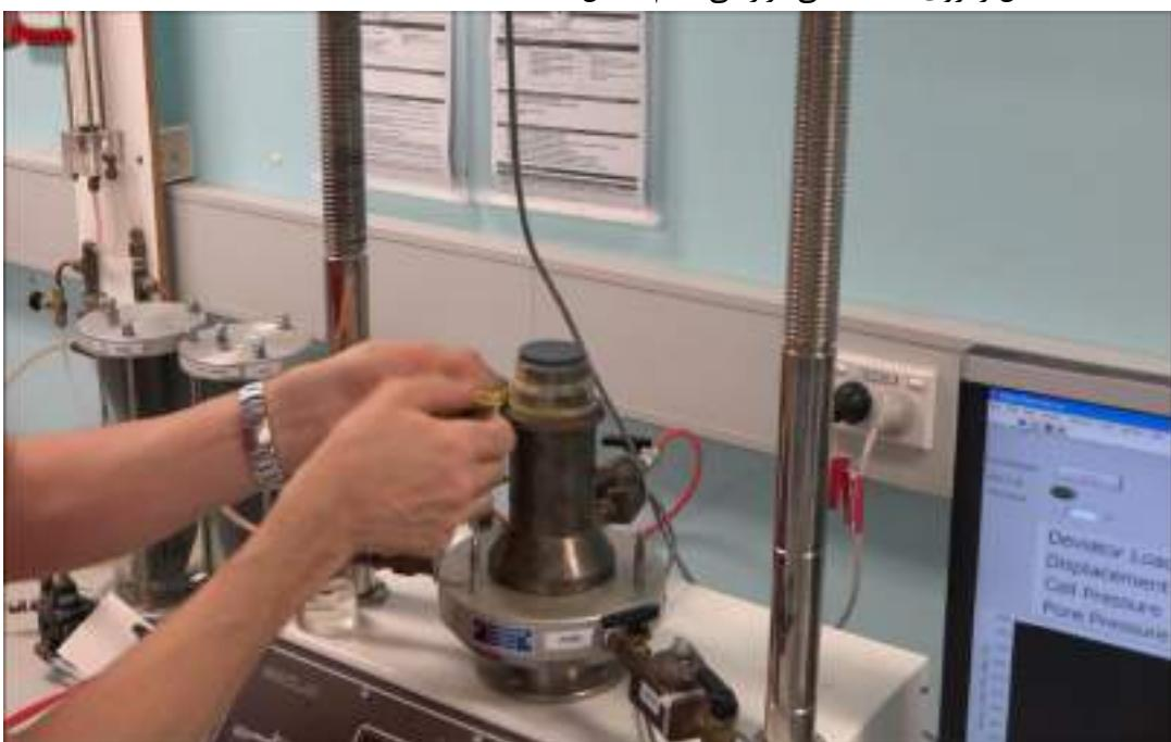
شکل ۷۷-۱۸: قرار دادن سنگ متخلخل روی کاغذ صافی
