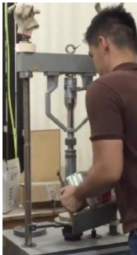
شکل ۱۳-۴۲: قرار دادن قالب همراه سربارهای آن در دستگاه
