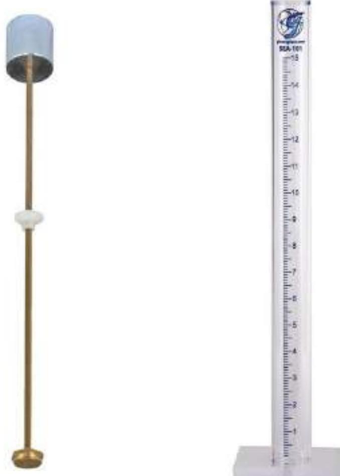
شکل ۷-۲: سنبه فولادی نشانه‌دار
