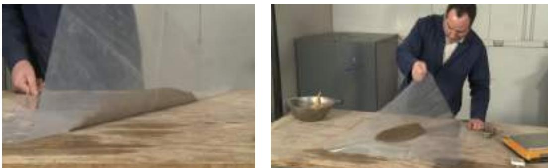
شکل ۷-۳۱: مخلوط کردن نمونه به صورت قطری
