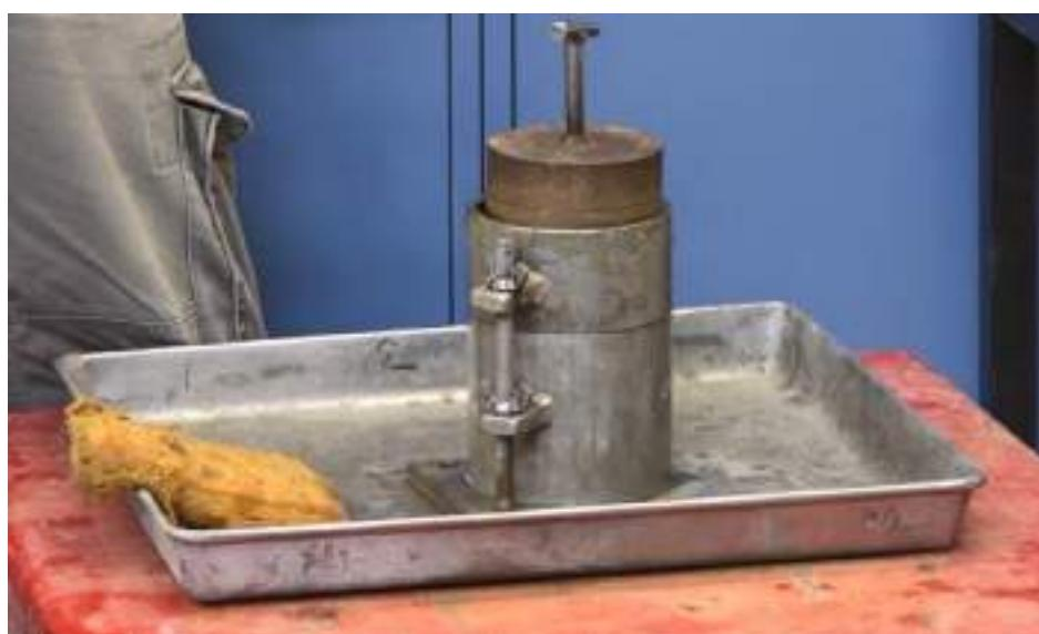
شکل ۲۰-۱۱: ارتعاش قالب روی میز ارتعاش مکانیکی با سربار
