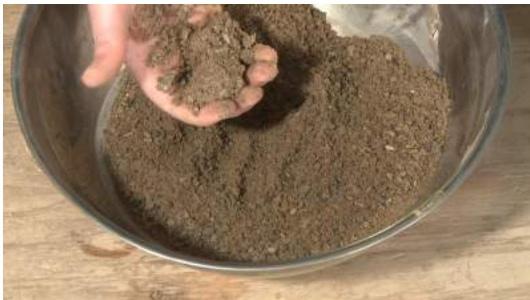
شکل ۷-۲۷: شکل به دست آمده از نمونه خیلی خشک ترک خورده پس از بازکردن دست
