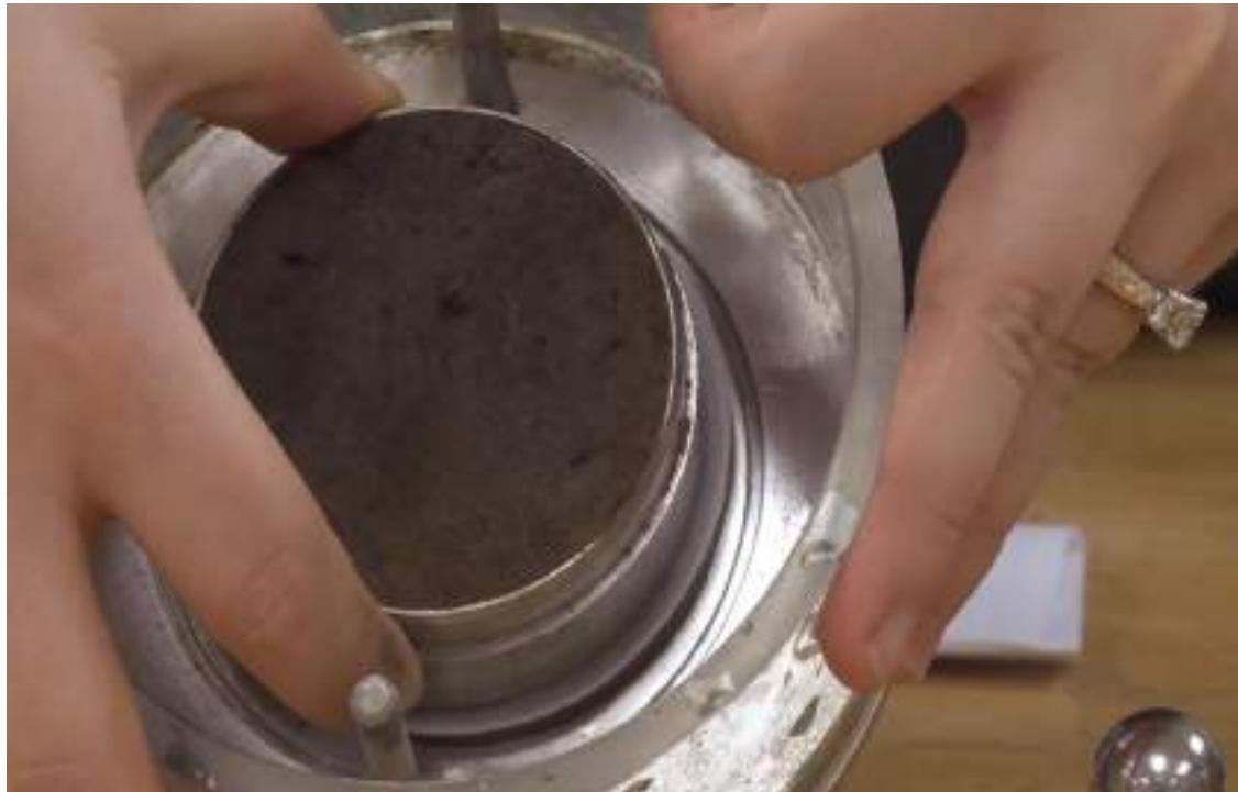
شکل ۴۸-۱۴: قرار دادن نمونه روی کاغذ صافی در سلول دستگاه تحکیم از نمای بالایی
