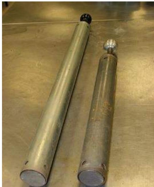
شکل ۲۲-۱۰: چکش‌های آزمایش تراکم: آزمایش پروکتور استاندارد (شکل سمت راست) و آزمایش پروکتور اصلاح شده (شکل سمت چپ)
