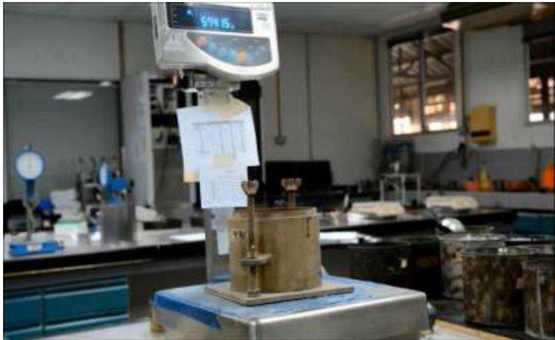
شکل ۳۱-۱۳: اندازه‌گیری جرم قالب تراکم
