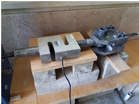
شکل ۲- نحوه‌ی قرار گیری نیرو سنج در دستگاه پیش تنیدگی
