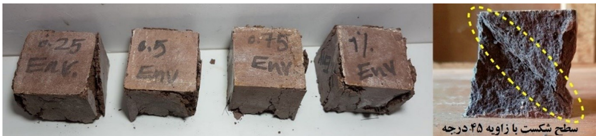
شکل ۳- نحوه شکست نمونه‌های مکعبی ملات ژئوپلیمری بدون الیاف و الیافی در آزمایش مقاومت فشاری در سن ۲۸ روز
