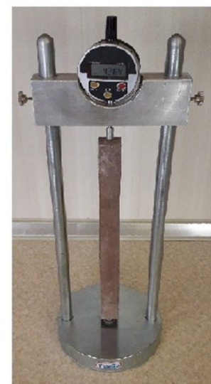
شکل ۶- دستگاه اندازه گیری جمع شدگی خشک ملات و نتایج اندازه گیری درصد تغییر طول نمونه ها به طول اولیه
