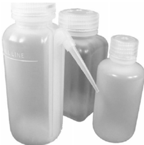
شکل 4-1: بطری‌های ساده مدرج برای جمع آوری نمونه‌های آب حاوی فیتوپلانکتون. دهانه (لوله) جلویی به مشاهده کننده، اجازه خروج اندازه مشخصی از نمونه را جهت مطالعه می‌دهد.
