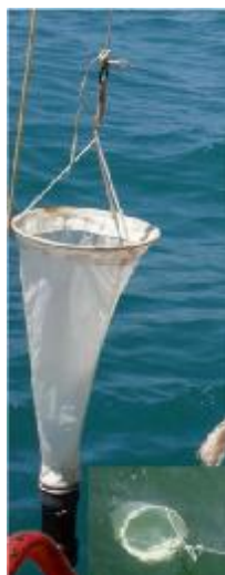
شکل 4-4 تصویری از یک تور پلانکتون معمول که برای جمع آوری فیتوپلانکتون کشیده شده است (تصویر ارائه شده از www.nearhus.gr )
