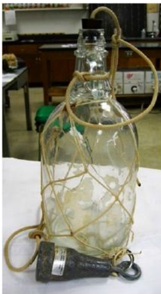
شکل 2-4 یک بطری نمونه بردار آب مایر (Meyer)
