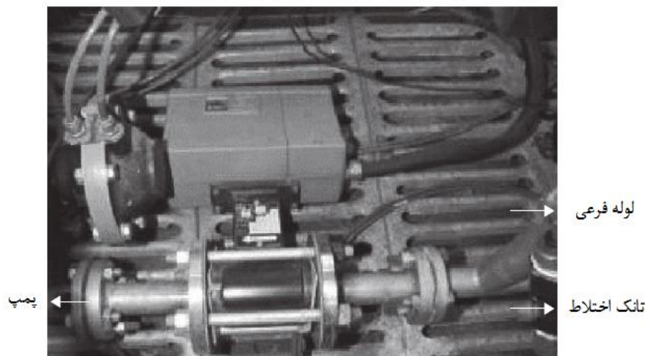
شکل ۱۳.۷. جریان سنج الکترومغناطیسی متصل به ماشین بوبین رنگ کنی آزمایشگاهی.
