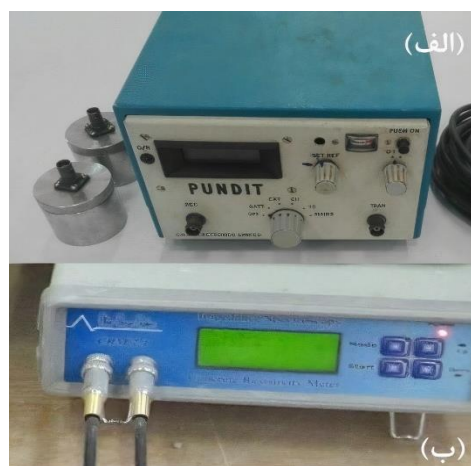
شکل ۲- الف) دستگاه اندازه‌گیری سرعت امواج اولتراسونیک، ب) مقاومت الکتریکی
