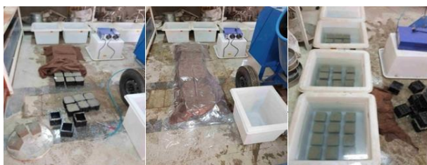
شکل ۶- تصاویری از نحوه عمل‌آوری آزمون‌های بتنی و قرارگیری آنها در حوضچه آب
