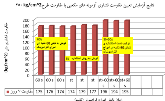
شکل ۷- مقایسه نتایج مقاومت فشاری با مقاومت طرح 250 \text{ kg/cm}^2 در سنین ۷ و ۲۸ روز
