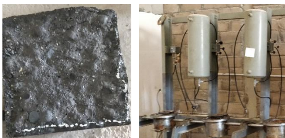
شکل ۱۱- آزمایش نفوذ پذیری، (الف) دستگاه آزمایش نفوذپذیری، (ب) اندازه‌گیری مقدار نفوذ آب در نمونه
