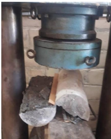
شکل 6- دستگاه آزمایش کششی به روش برزلی
