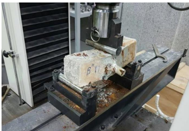
شکل ۵- تست مقاومت خمشی تک نقطه ای
