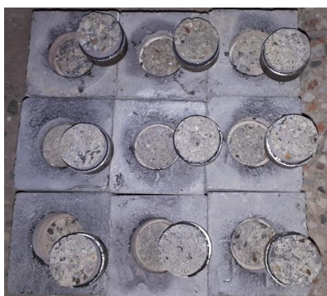
شکل ۲- نمونه‌ها قبل و بعد از آزمایش چسبندگی لایه
