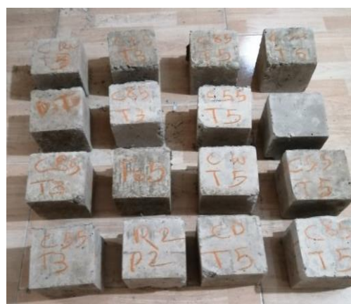
شکل ۲- نمونه‌ها قبل و بعد از آزمایش چسبندگی لایه
