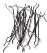
شکل ۱- الیاف فولادی قلابدار مورد استفاده در لایه تعمیر
