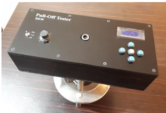
شکل ۳- دستگاه سنجش چسبندگی لایه
