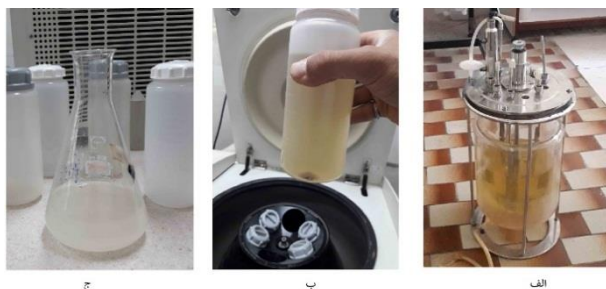
شکل ۴- کشت و تولید باکتری مورد نیاز. الف: کشت باکتری در فرماتور. ب: سانتریفیوژ کردن محلول باکتری. ج: محلول باکتری پس از کشت و سانتریفیوژ
