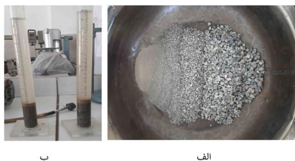
شکل ۵- الف: دانه بندی سنگ دانه ها. ب: آزمایش تمیزی ماسه
