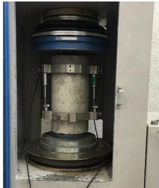
شکل ۶- جزئیات و نحوه قرارگیری نمونه برای تعیین منحنی تنش-کرنش فشاری
