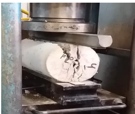
شکل ۴- نمونه آزمایش مقاومت کششی (شکافت برزلی) انجام شده
