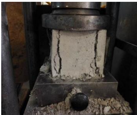
شکل ۳- نمونه آزمایش مقاومت فشاری انجام شده
