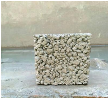
شکل ۴- نمونه مکعبی به ابعاد ۱۵ سانتیمتر جهت انجام آزمایش مقاومت فشاری
