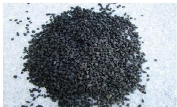
شکل ۱- خرده لاستیک ضایعاتی مورد استفاده در ساخت بتن
