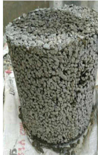
شکل ۵- نمونه استوانه‌ای آزمایش مقاومت کششی
