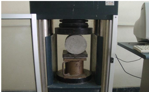
شکل ۳- فرآیند ایجاد پیش ترک بر روی نمونه‌های بتنی
