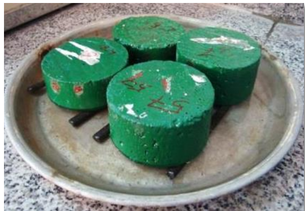
شکل ۸- شمایی از آزمایش جذب آب موئینه.
