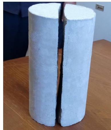
شکل ۱۴- نحوه شکست نمونه های استوانه ای
