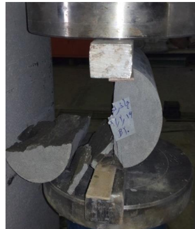
شکل ۱۳- نحوه اعمال بار بر نمونه های استوانه ای
