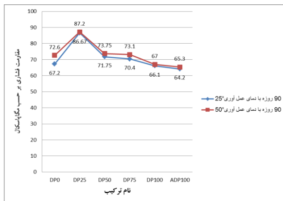
شکل ۸- مقاومت فشاری ترکیبات در سن ۹۰ روزه و در دو
