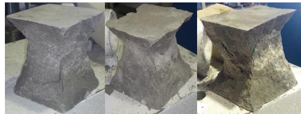
شکل ۹- برخی از شکست‌های مطلوب نمونه‌ها
