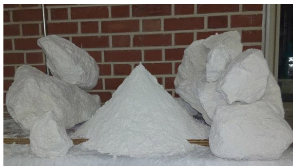
شکل ۱- پودر دیاتومیت مصرفی در ساخت نمونه‌ها
