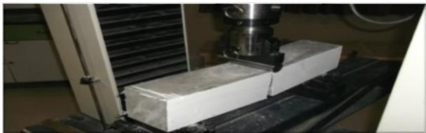
شکل ۴- آزمایش خمش سه نقطه‌ای با استفاده از دستگاه کشش یونیورسال
