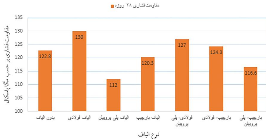
شکل ۲- مقاومت فشاری ۲۸ روزه‌ی نمونه‌های مکعبی
