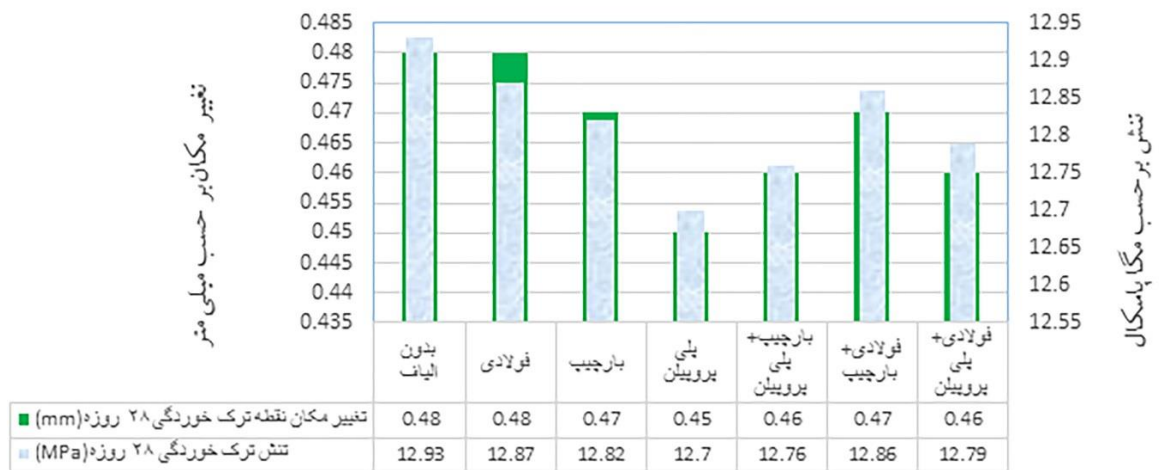
شکل ۶- تنش و تغییر مکان نقطه‌ی ترک خوردگی در سن ۲۸ روز
