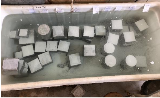
شکل ۷- حوضچه عمل آوری نمونه های بتن
