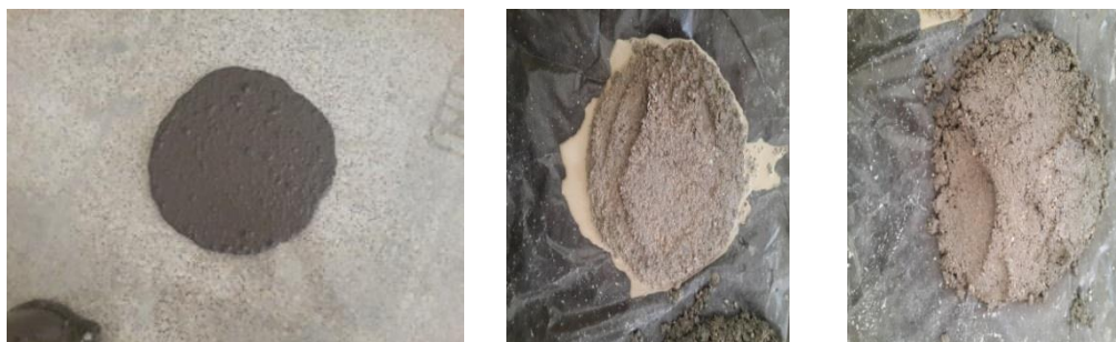
الف: بتن بدون خاصیت خودتراکمی؛ ب: بتن آب انداخته؛ پ: بتن با خاصیت خودتراکمی
