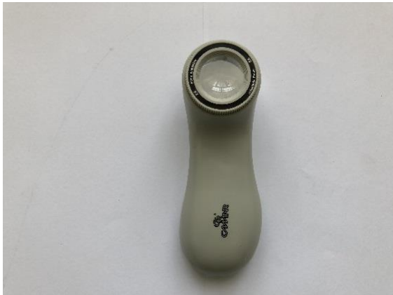
شکل ۱۱- ذره بین مدرج برای اندازه گیری عرض ترک
