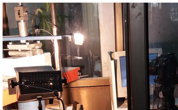
شکل ۶- دستگاه اندازه‌گیری خمشی چهار نقطه‌ای و متعلقات آن
