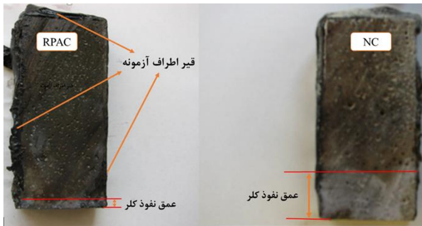
شکل ۵- آزمون‌های مورد استفاده از بتن NC و بتن RPAC در آزمایش اندازه‌گیری عمق نفوذ کلر
