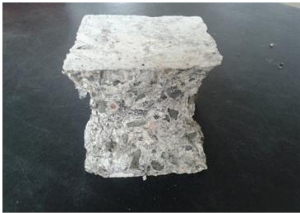
شکل ۲- نحوه شکست نمونه های مکعبی تحت آزمایش مقاومت فشاری
