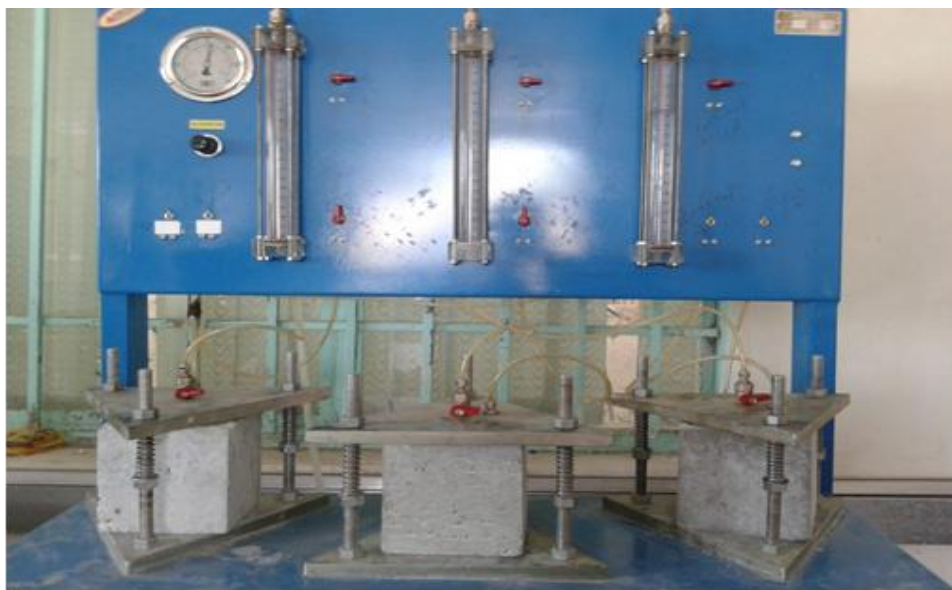
شکل ۳- دستگاه آزمایش نفوذپذیری نمونه های مکعبی
