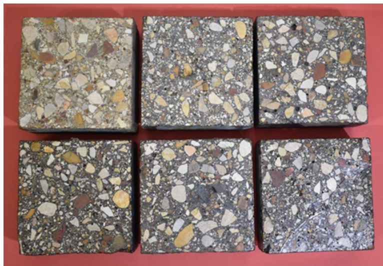
شکل ۱۰- مقایسه درون بتن طرح رنگی شده با دوده کربن با بتن معمولی (بتن برش خورده)
