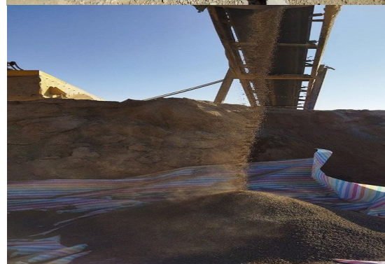
شکل ۱- تبدیل آزمون‌های بتنی به سنگ‌دانه از طریق خردایش
