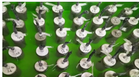
شکل ۴- قراردادن آزمون‌ها در محلول ۱۰ درصد NaCl
