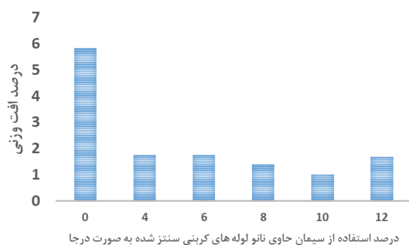
شکل ۴- میزان افت وزنی نمونه‌های بتنی پس از قرارگیری در معرض ۳۰۰ چرخه ذوب و یخ
