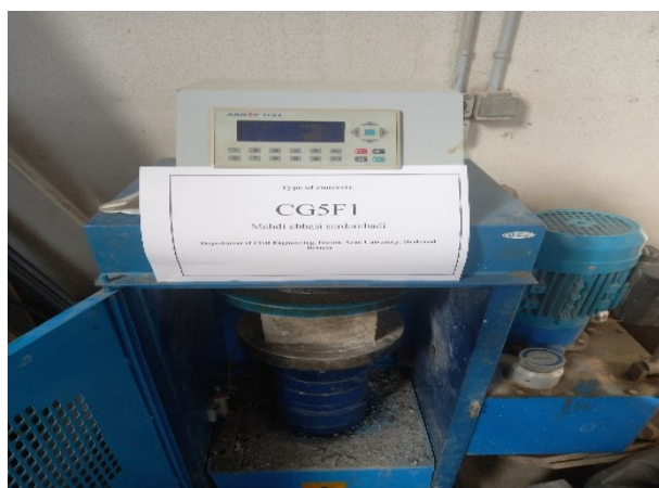
شکل ۴- شکست مقاومت فشاری و انتشار ترک (CG5F1)
