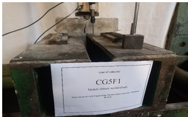
شکل ۷- شکست مقاومت خمشی و انتشار ترک (CG5F1)
