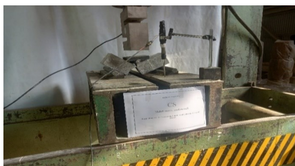
شکل ۶- شکست مقاومت خمشی و انتشار ترک (CS)
