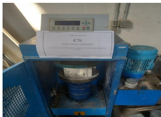
شکل ۳- شکست مقاومت فشاری و انتشار ترک (CS)
