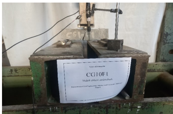
شکل ۸- شکست مقاومت خمشی و انتشار ترک (CG10F1)
