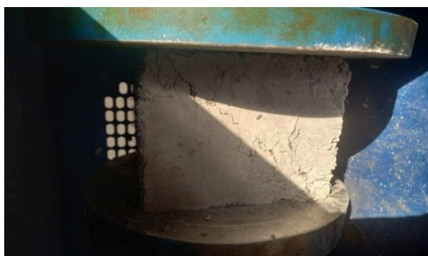
شکل ۵- شکست مقاومت فشاری و انتشار ترک (CG10F1)
