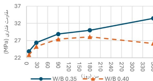
شکل ۷- تأثیر نسبت آب به مواد سیمانی بر مقاومت فشاری در طول زمان
