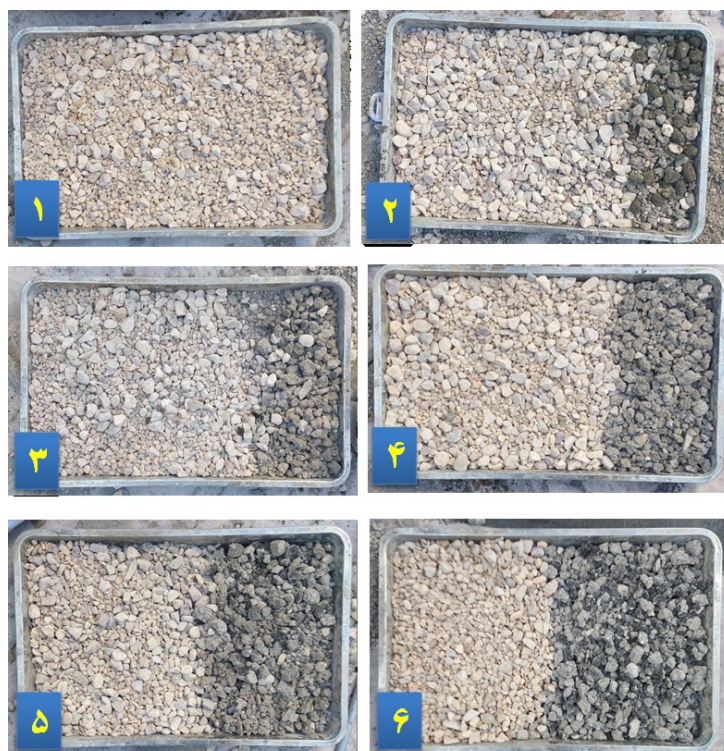
شکل ۲- جایگزینی حجمی درشت‌دانه آسفالت ضایعاتی با شن طبیعی (تصویر شماره ۱ الی ۶ به ترتیب نسبت سنگ‌دانه طرح مخلوط CONTROL, AS10%, AS20%, AS30%, AS40%, AS50% را نشان می‌دهد).
