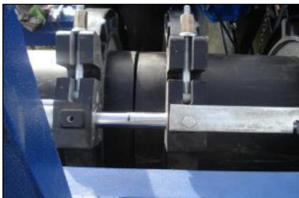
شکل ۶-۶- نحوه قرار گرفتن لوله‌ها در جوش لب‌به‌لب
