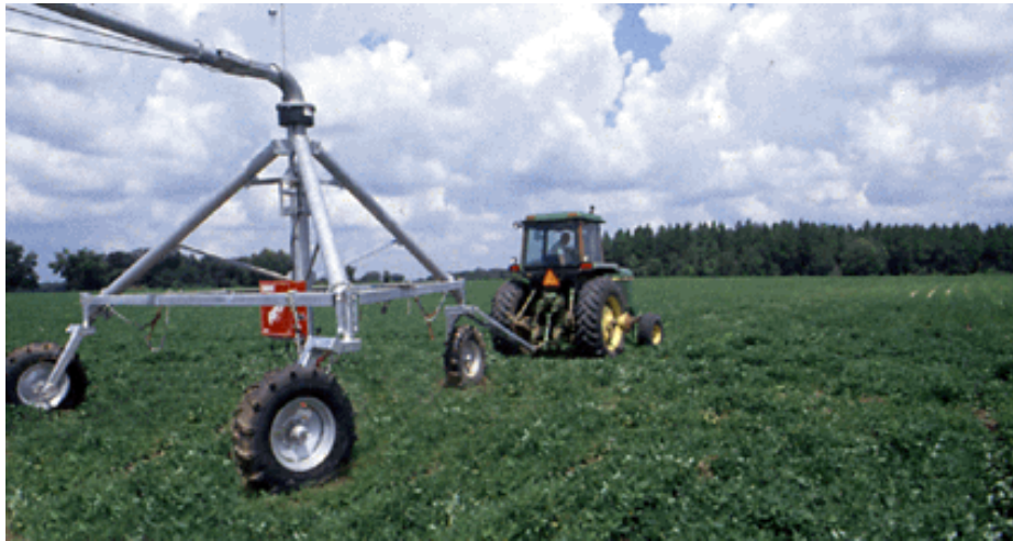
شکل ۲-۹- سامانه سنتریپوت با قابلیت انتقال به سایر مزارع
