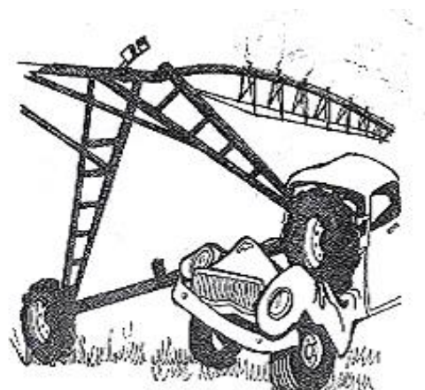
شکل ۸-۲۴- برخورد دستگاه با موانع موجود در مسیر حرکت آن
