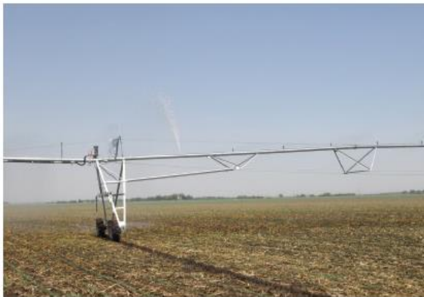
شکل ۸-۴- یک دستگاه ماشین سنتریوت با یک آبپاش گم‌شده
