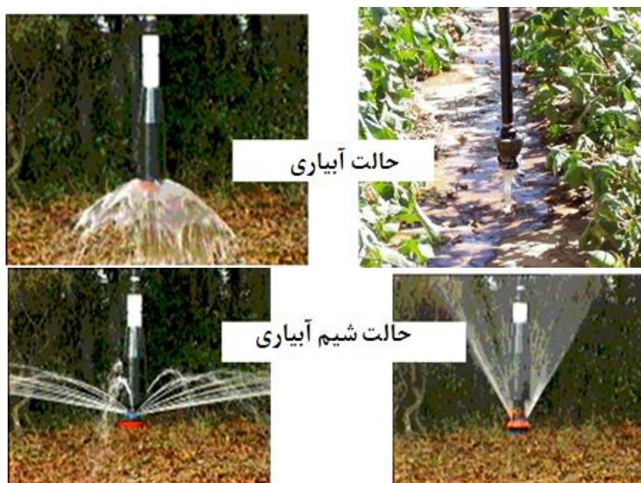
شکل ۲-۳۰- حالت‌های مختلف پخش آب در سامانه سنتریپوت شامل حالت آبیاری و حالت شیم آبیاری
