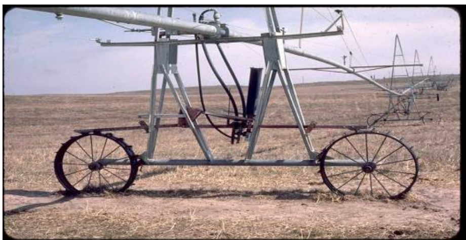
شکل ۲-۵- سامانه سنتریپوت اولیه با چرخ‌های فلزی و موتور محرکه با تغذیه از فشار آب موجود در سامانه
