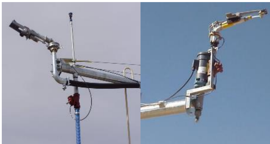
شکل ۲-۱۷- دو نوع آبپاش انتهایی با و بدون پمپ بوستر
