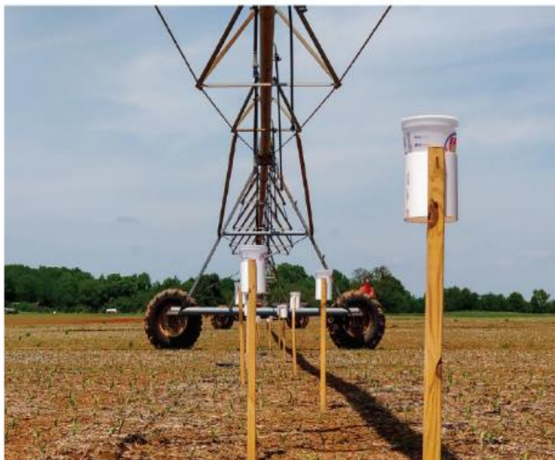
شکل ۸-۲- آزمایش یکنواختی پاشش زیر یک دستگاه ماشین آبیاری سنتریوت
