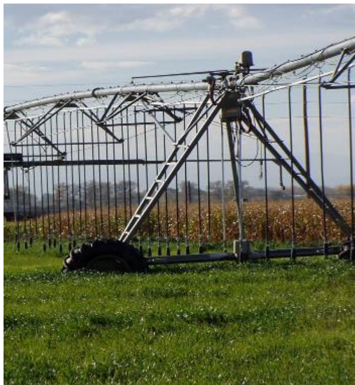
شکل ۲-۱۴- بر ج A شکل سامانه سنتریپوت در محل اتصال دو دهانه مجاور
