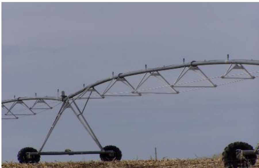
شکل ۲-۱۵- دهانه و نحوه قرارگیری خرپا، کابل و آبپاش روی آن
