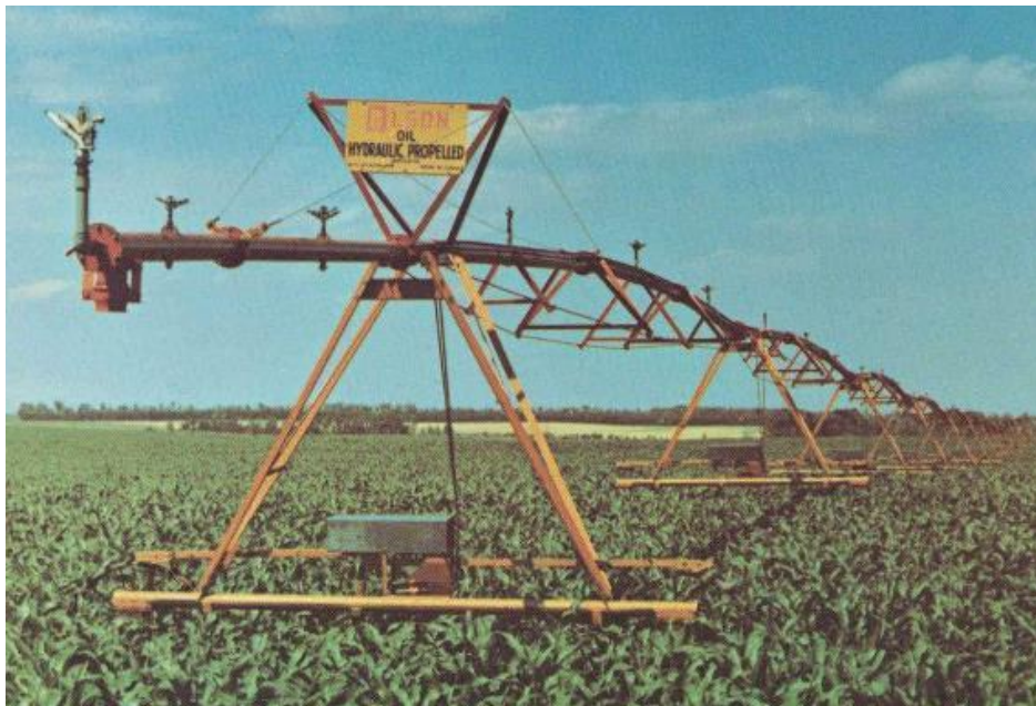
شکل ۲-۸- استفاده از آبپاش انتهایی برای پوشش بخشی از گوشه‌های زمین و جلوگیری از اتلاف آن
