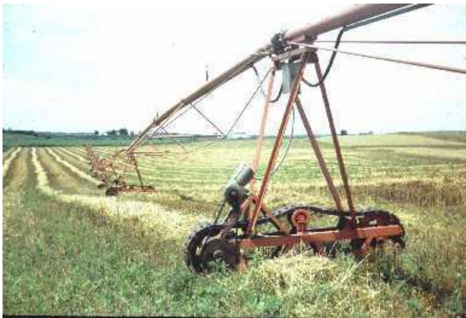
شکل ۲-۷- سامانه سنتریوت ساخته شده توسط شرکت رینکت و استفاده از شنی برای حرکت بهتر در خاک مرطوب
