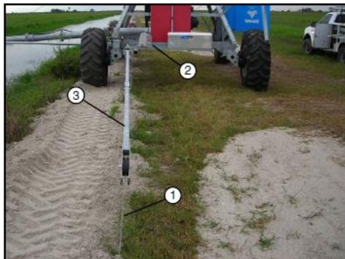
شکل ۸-۲۵- سیستم هدایت کابل روزمینی (۱- کابل ۲- باکس هدایت ۳- بازوی کنترل)
