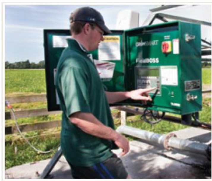
شکل ۸-۱۴- تنظیم سرعت حرکت دستگاه از طریق تابلوی مرکزی
