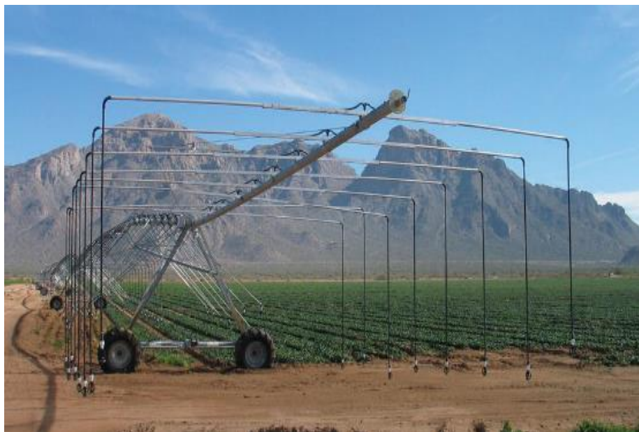
شکل ۸-۸- تصویر یک دستگاه سنتریوت مجهز به سامانه بوم برای جلوگیری از روان آب
