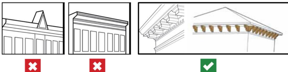
شکل ۲۰. استفاده از کنگره‌سازی در محل اتصال جداره به بام
