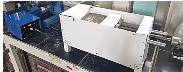
الف) نمونه مکعبی بتن تحت میدان مغناطیسی
