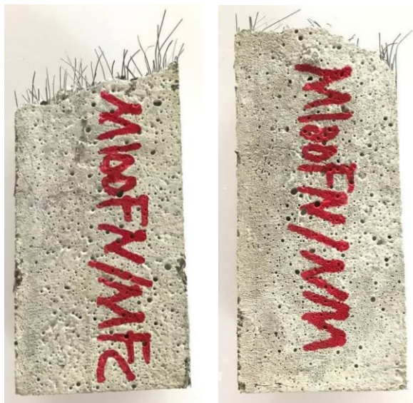
الف) بتن غیرمغناطیسی ب) بتن مغناطیسی
