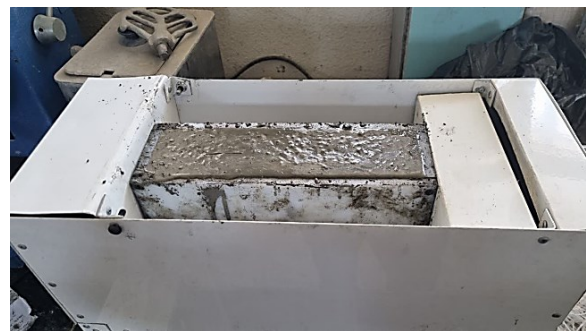
ب) نمونه منشوری بتن تحت میدان مغناطیسی
