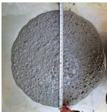
شکل ۲- آزمایش جریان اسلامپ بتن خودتراکم
