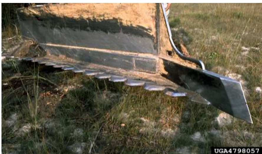
تصویر ۲-۲: نمونه‌هایی از تیغه‌های مخصوص برای بریدن علف‌های بلند و بوته‌های خشبی در سطح عرصه جنگل کاری
