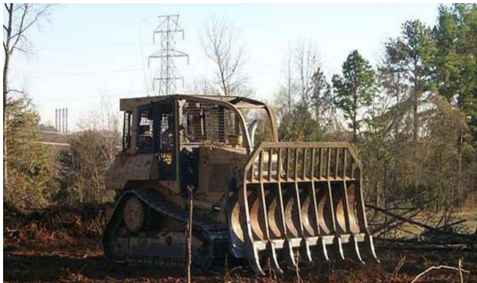
تصویر ۲-۴: نوعی شن‌کش نصب‌شده در جلوی تراکتور برای درآوردن قلوه‌سنگ‌های درشت و کندن ریشه و کنده‌های باقیمانده در خاک
