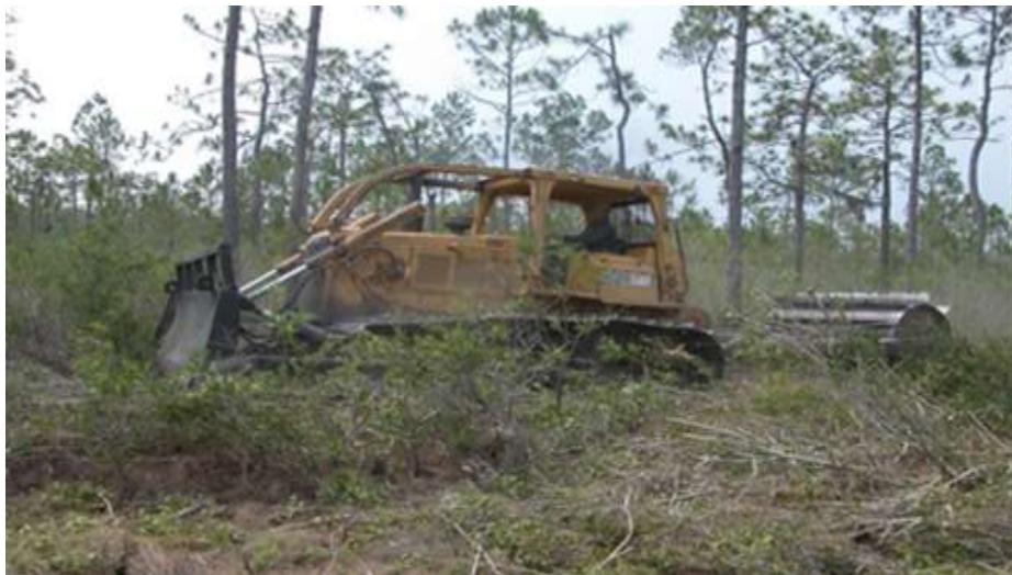
تصویر ۲-۵: تراکتور با تیغه‌های بلند در جلو درختچه‌ها و درختان کوچک را قطع می‌کند و با غلتک تیغه‌دار عقب بقایای چوبی را خرد می‌کند
