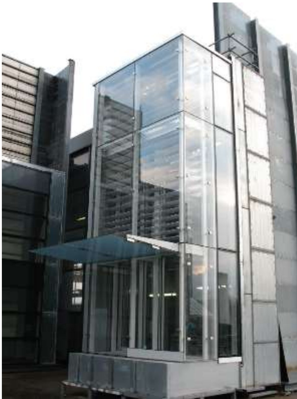
شکل ۸-۳-۲۴. گارتنر، ماکت بخشی از مجموعه نمای دوپوسته را برای نفوذ هوا، فشار، نفوذ آب و تغییر شکل لرزه‌ای ساخت و آزمایش کرد. منبع: همکاران معماران، شرکت ویلیام راون.
