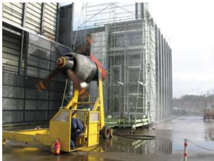
شکل ۷-۸. ماکت و تست عملکرد نما در مقیاس کامل برای کتابخانه عمومی کمبریج، ژوزف گارتنر جیم بی اف ۱ این ماکت را ساخت و مجموعه را برای نفوذ هوا، فشار، نفوذ آب و تغییر شکل لرزه‌ای در تأسیسات گاندلفینگن ۲ آلمان آزمایش کرد، منبع: ویلیام راوون و همکاران.
