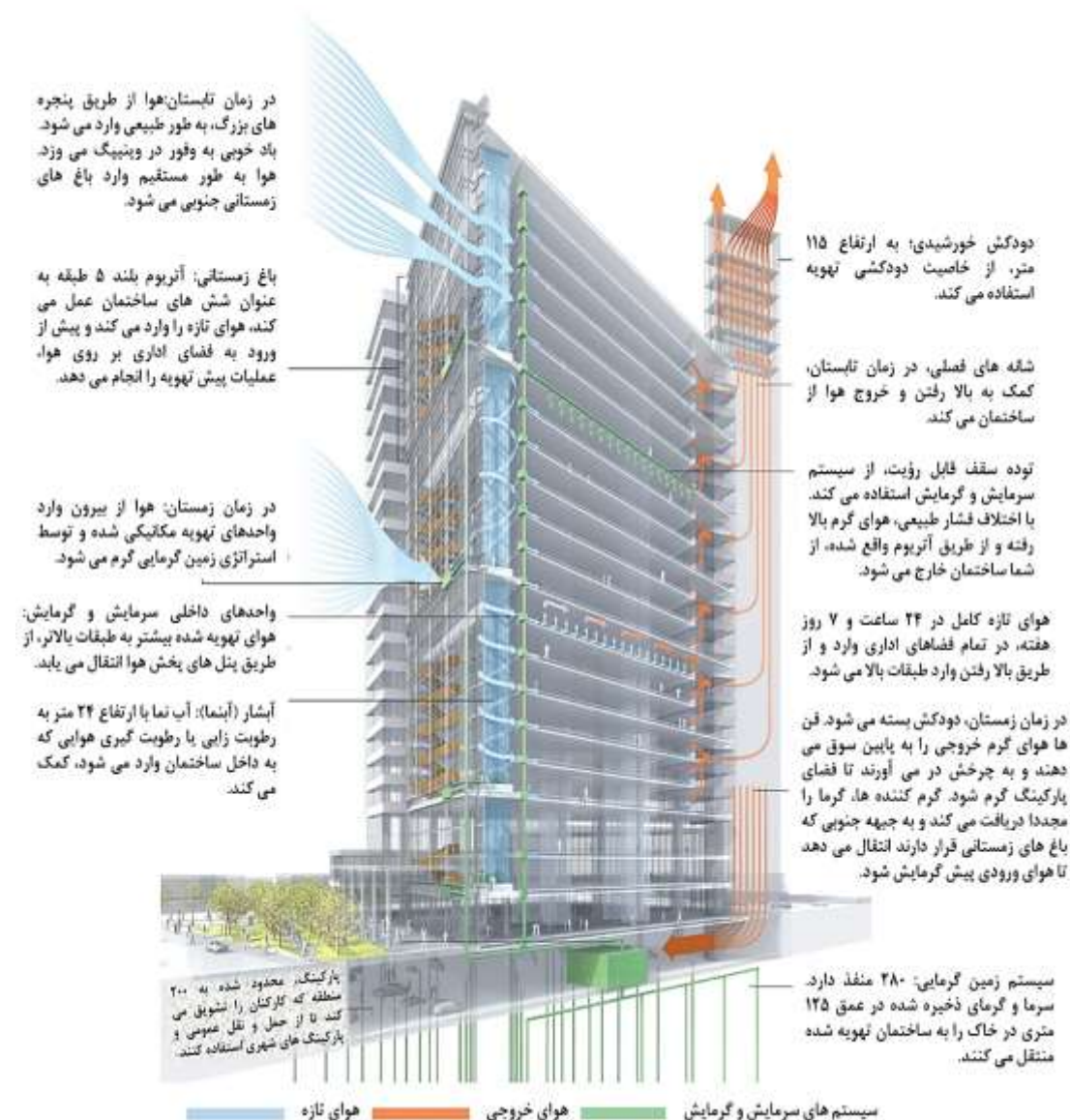
شکل ۸-۴-۱۲. تصویری از گرمایش/سرمایش منبع زمینی و جریان هوا در سراسر شرکت هیدرو پلیس مانیئوبا. منبع: کی پی ام بی.
