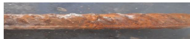
شکل ۸- اثر خوردگی بر میلگردها در خوردگی ۱۵ درصد
