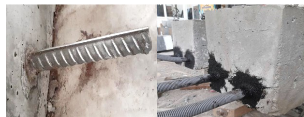
شکل ۴- اتصال سیم به میلگرد کششی و عایق‌بندی آن
