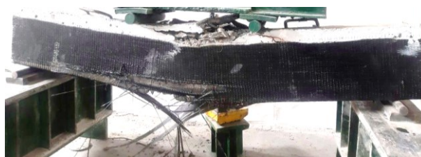
شکل ۱۱- جدا شدن ورق FRP از وجه کششی نمونه‌ی
