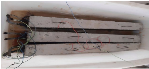
شکل ۵- قرارگیری نمونه‌ها داخل حوضچه
