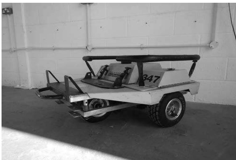
شکل ۴-۵: آزمایشگر گریپ (John Prime)
