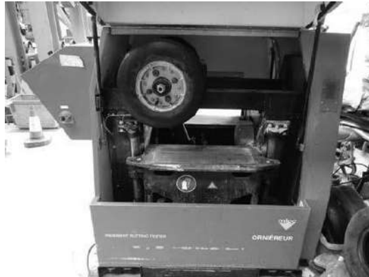
شکل ۵-۳: دستگاه بزرگ برای آزمایش اثر بار چرخ CEN (با کسب اجازه از جان پرایم)
