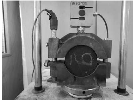
شکل ۵-۲: قالب شکست آزمایش مارشال (با کسب اجازه از جان پرایم)
