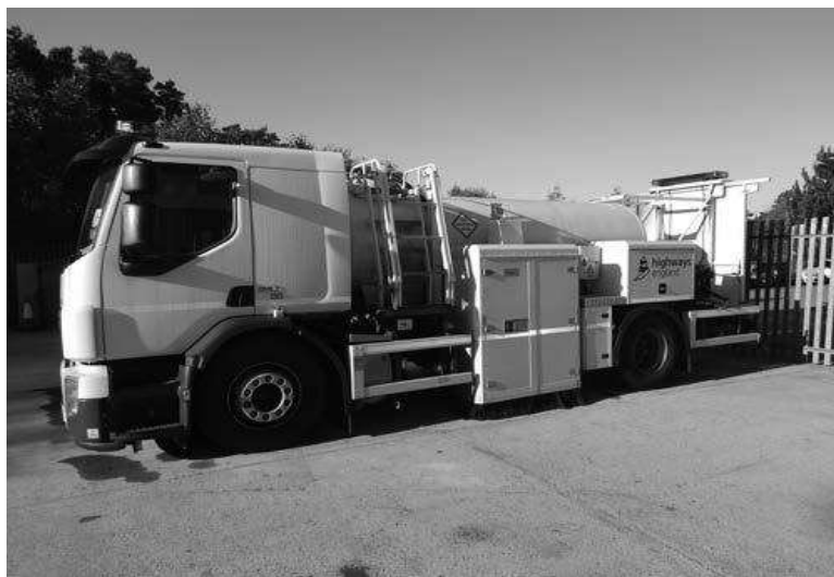
شکل ۴-۴: دستگاه متداول اندازه‌گیری ضریب نیرو جانبی (John Prime)
