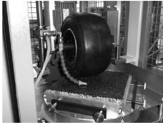
شکل ۵-۹: دستگاه سایش دارمشتات (با کسب اجازه از مرکز تحقیقات جاده‌ها)
