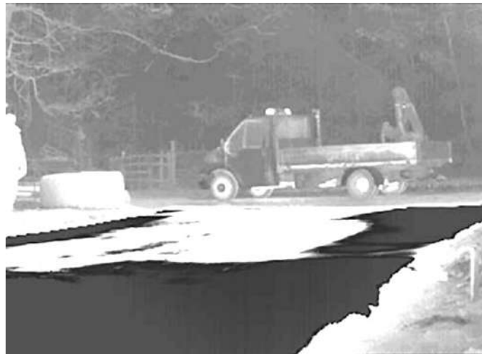
شکل ۳-۳: مثالی از ترسیم ترموگرافیک آسفالت هنگام روسازی (با کسب اجازه از پیتر دی ساندرز)
