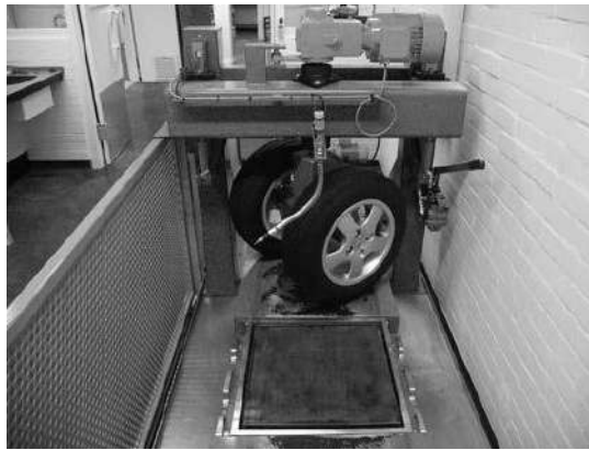
شکل ۵-۸: دستگاه آزمایش شن‌زدگی آخن (BAM Infra Asphalt.)
