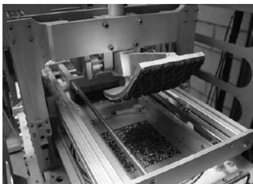
شکل ۵-۱۱: دستگاه آزمایش مصالح زدگی (با کسب اجازه از موسسه علوم و فن آوری حمل و نقل، برنامه‌ریزی و شبکه فرانسه)
