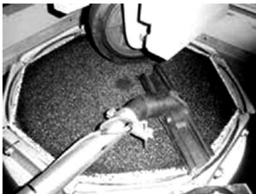
شکل ۵-۱۰: دستگاه آزمایش سایش سطح دوار (با کسب اجازه از Heijmans Infrastructuuren Milieu)
