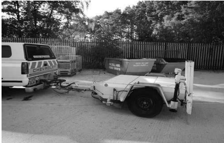
شکل ۴-۶: سنجشگر اصطکاک روسازی (John Prime)
