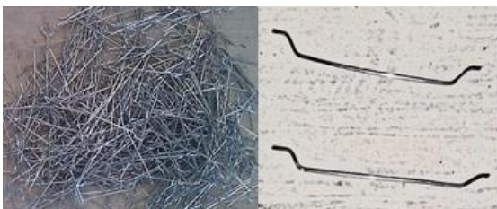
شکل ۲- الیاف فولادی دو انتها قلاب‌دار
