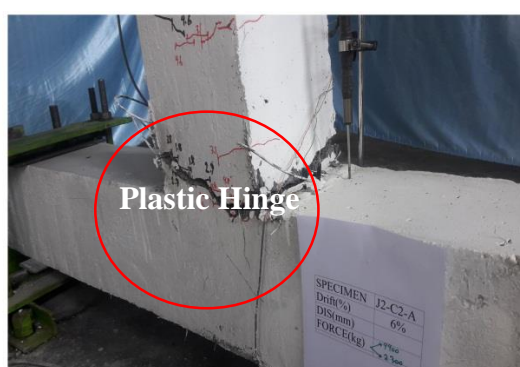
ب - ایجاد مفصل پلاستیک در نمونه HPFRCC در زاویه دریافت ۶٪
