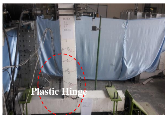
ب - ایجاد مفصل پلاستیک در نمونه HPFRCC در زاویه دریافت ۶٪
