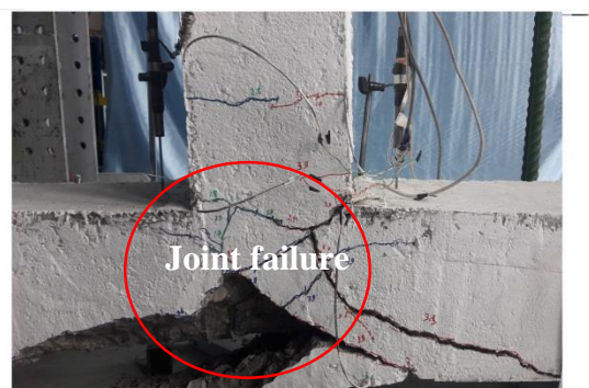
الف - گسیختگی برشی نمونه بتن معمولی در زاویه دریافت ۶٪
