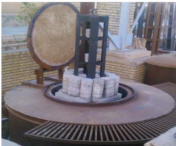
شکل ۳- کوره‌ی مورد استفاده برای اعمال حرارت
