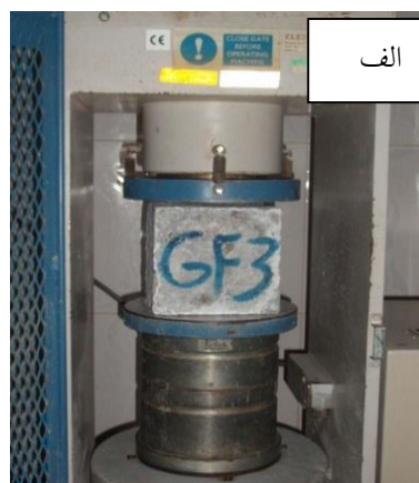
شکل ۴- دستگاه‌های تست مقاومت (الف- جک تعیین مقاومت فشاری ب- جک تعیین مقاومت کششی)
