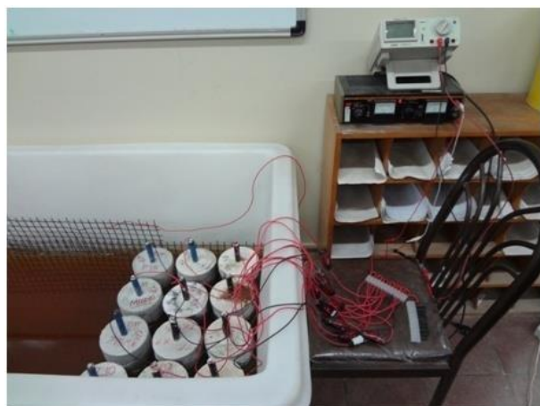
شکل ۴- نحوه انجام آزمایش خوردگی تسریع شده
